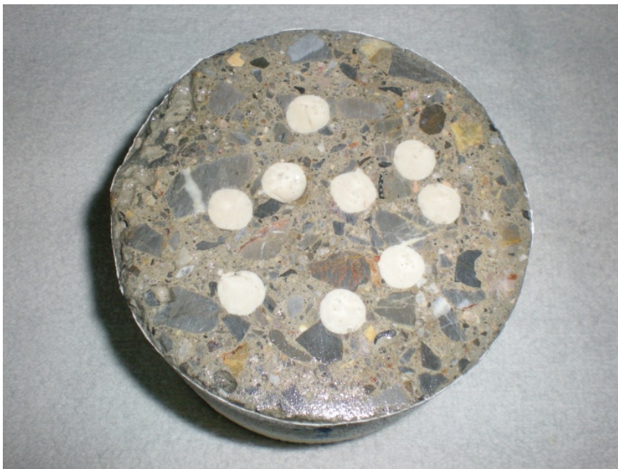
ΣΧΗΜΑ 7: Επισκευασμένο δοκίμιο σκυροδέματος
