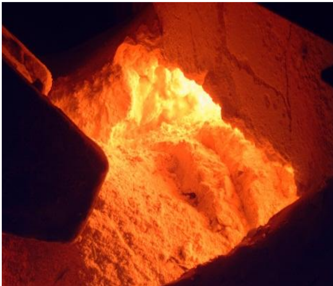
Σχήμα 12.4 Εισαγωγή μείγματος στο φούρνο [42]
