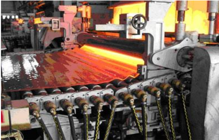
Σχήμα 12.6 Έλαση για παραγωγή επίπεδου γυαλιού [44]
