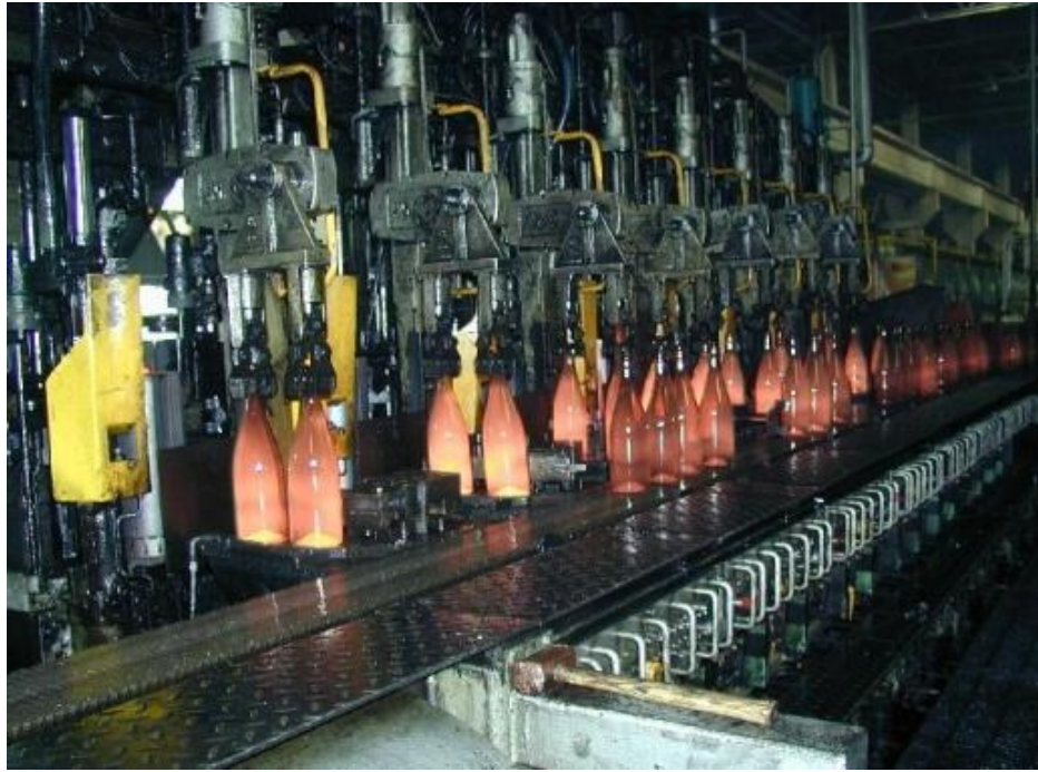
Σχήμα 12.2 Διαδικασία παραγωγής γυάλινων δοχείων [38]
