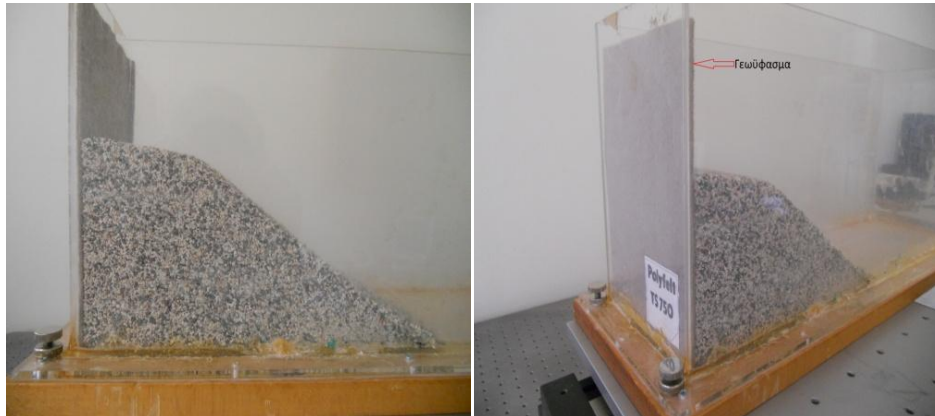
Εικόνα 3.10 : Τοποθέτηση γεωϋφάσματος στην επιφάνεια επαφής της άμμου με το plexiglass
