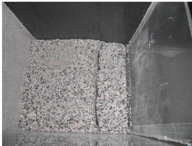
Εικόνα 3.24: Αστοχία του εδάφους αριστερά του διαφράγματος πριν πέσει το διάφραγμα
