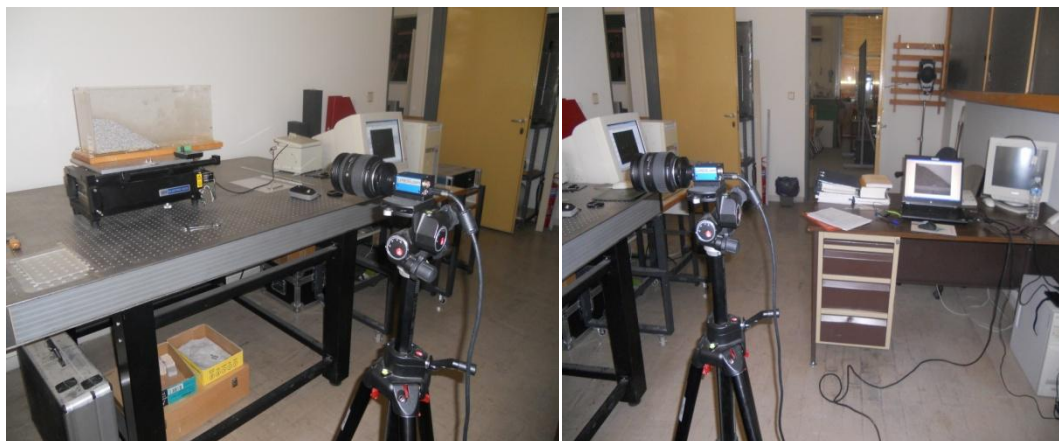
Εικόνα 2.2: Εικόνες από την εργαστηριακή διάταξη του Vic-2D
