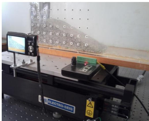
Εικόνα 3.9: Τοποθέτηση ψηφιακής φωτογραφικής μηχανής για την καταγραφή βίντεο του πειράματος
