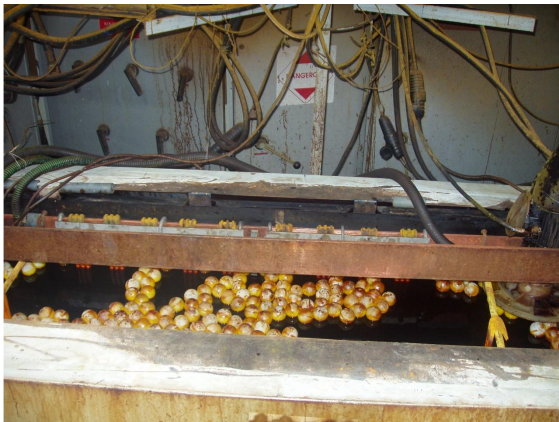
Εικόνα 5-6: Η δεξαμενή του διαλύματος επιχρωμίωσης. Διακρίνονται τα πλαστικά σφαιρίδια για τη δέσμευση των αέριων εκπομπών.
