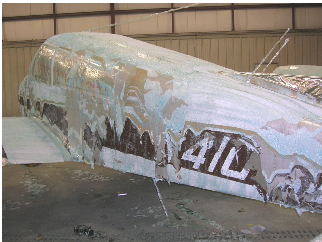
Εικόνα 1-2: Απόχρωση αεροσκάφους με εφαρμογή χημικών αποχρωστικών (chemical stripping). Πηγή: Royal Aircraft Services, http://www.royalaircraft.com
