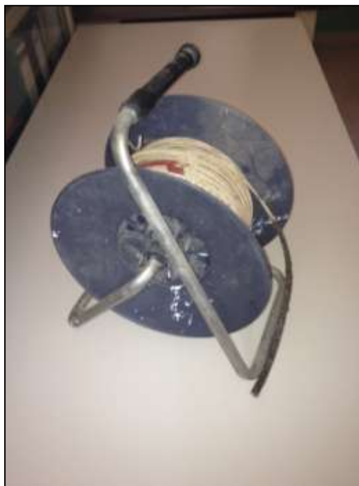
Εικόνα 36 Σταθμήμετρο που χρησιμοποιήθηκε για την μέτρηση του βάθους της υδροφορίας των πηγαδιών
