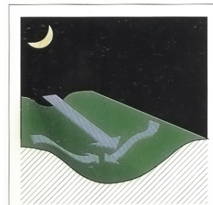
Εικ.24: Ανοδική και καθοδική κίνηση αέρα
