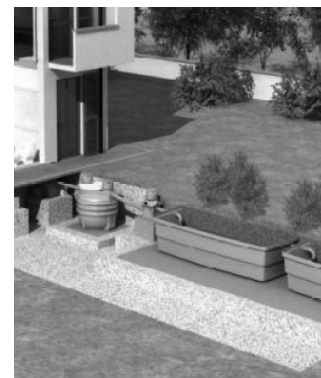
Εικ.5: Λεκάνες φυτοκαθαρισμού σε κατοικία
