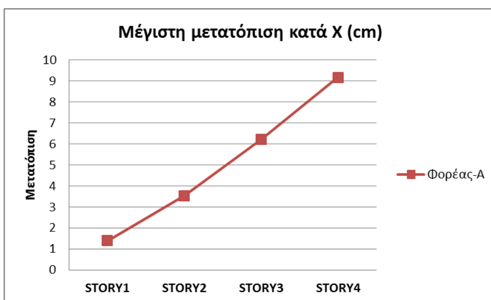
Εικόνα 4.4 : Διάγραμμα μέγιστων μετατοπίσεων ορόφων για E_X
