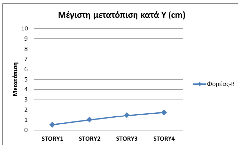
Εικόνα 6.5 : Διάγραμμα μέγιστων μετατοπίσεων ορόφων για E_Y
