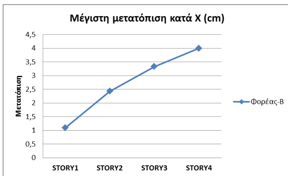
Εικόνα 6.4 : Διάγραμμα μέγιστων μετατοπίσεων ορόφων για E_X
