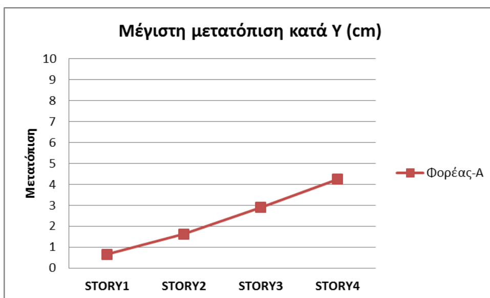
Εικόνα 4.5 : Διάγραμμα μέγιστων μετατοπίσεων ορόφων για E_Y
