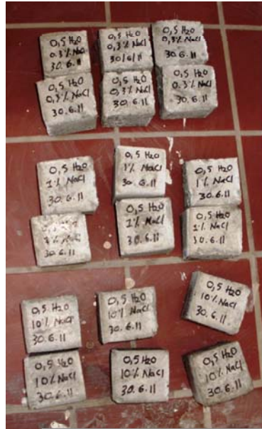
Εικόνα 6 : Κυβικά δοκίμια διαστάσεων 5cm x 5cm x 5cm έτοιμα για κρουσιμέτρηση
