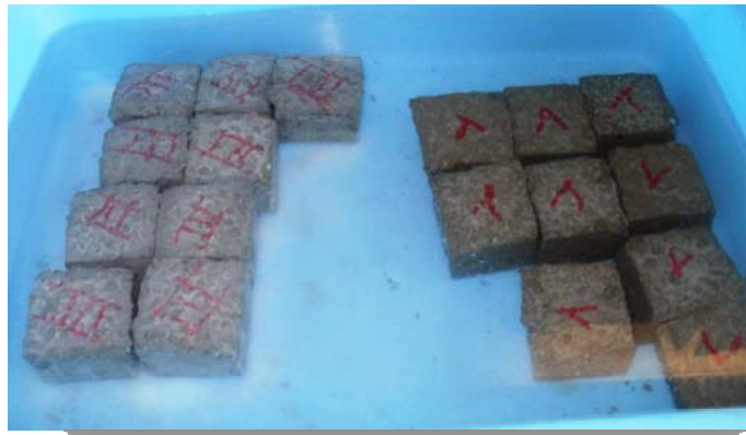
Εικόνα 14 : Κυβικά δοκίμια τοποθετημένα σε λεκάνη για ενυδάτωση.
