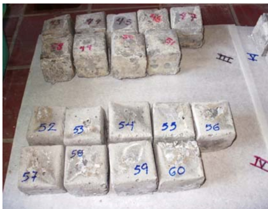
Εικόνα 13 : Κυβικά δοκίμια διαστάσεων 5cm x 5cm x 5cm έτοιμα για κρουσιμέτρηση
