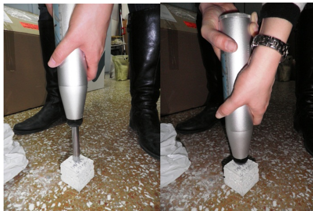
Εικόνα 1 : Κρουσιμέτρηση για την εύρεση της θλιπτικής αντοχής του σκυροδέματος
