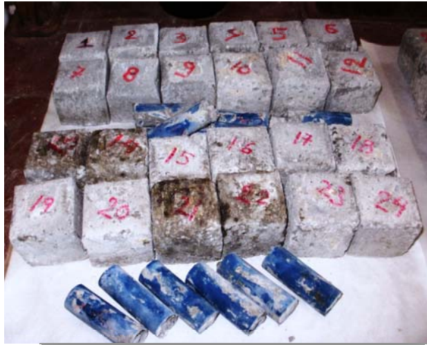
Εικόνα 11 : Κυβικά δοκίμια διαστάσεων 5cm x 5cm x 5cm έτοιμα για κρουσιμέτρηση
