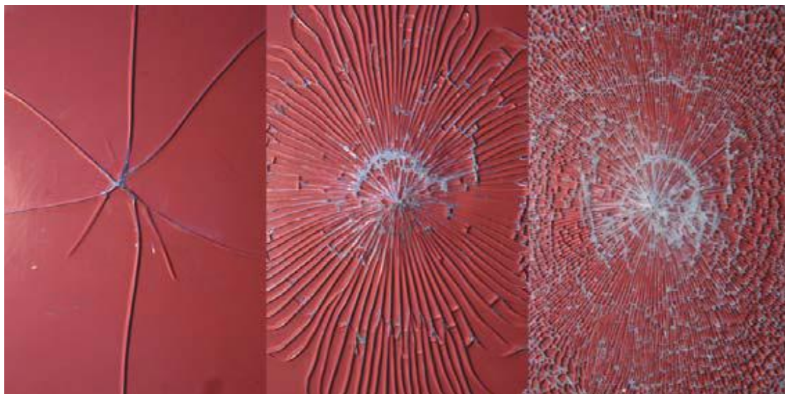
Εικόνα 2.1: Μορφή θραύσης γυαλιού. Από αριστερά ανοπτημένο , θερμικά ενισχυμένο, σκληρυμένο [6].
