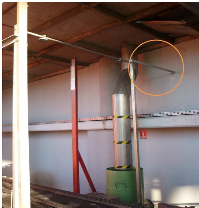
Εικόνα 2.9: Τοποθέτηση επιπλέον βάση στα φωτοκύτταρα ελέγχου στραβών παλετών.
