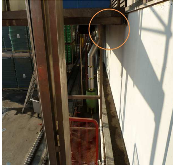
Εικόνα 2.8: Η βάση των φωτοκυττάρων ελέγχου στραβών παλετών δεν είναι σταθερή.
