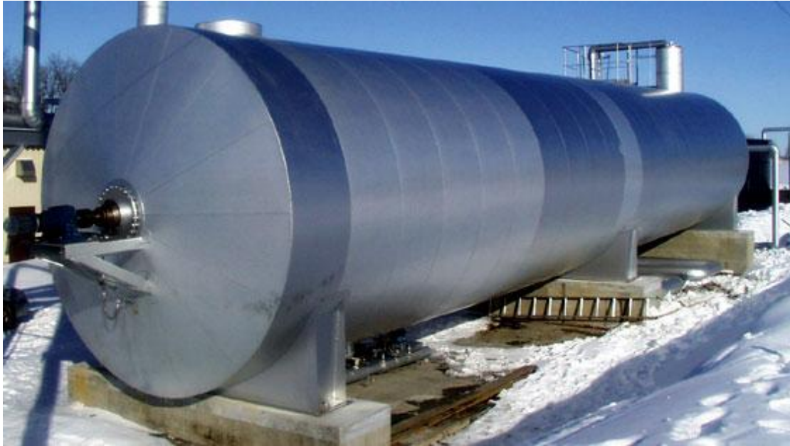
Εικόνα 2-3: Οριζόντιος χωνευτήρας, κατασκευασμένος στη Δανία.[22]
