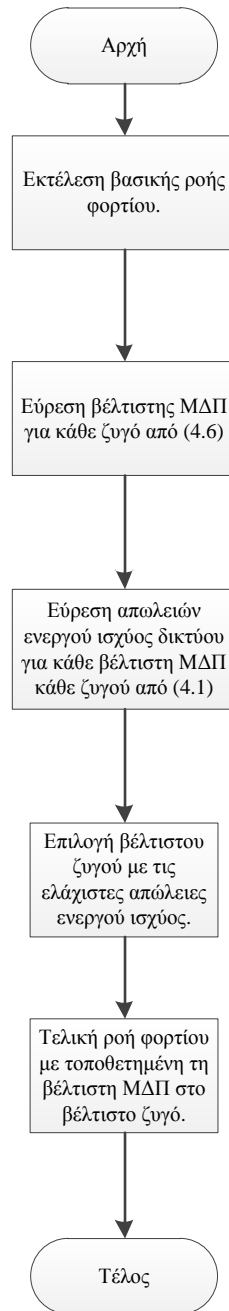
Σχήμα 4.2: Διάγραμμα ροής αλγορίθμου προτεινόμενης αναλυτικής μεθόδου με αντικειμενική συνάρτηση τη μείωση των απωλειών ενεργού ισχύος.
