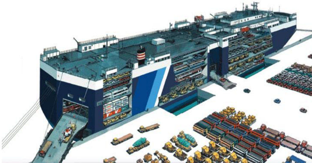
Εικόνα 4. Ράμπες φορτοεκφόρτωσης και εσωτερικά καταστρώματα ενός τυπικού PCC
