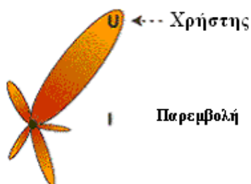
Σχήμα 3.2: Διάγραμμα ακτινοβολίας συστήματος προσαρμοστικών στοιχειοκεραιών
