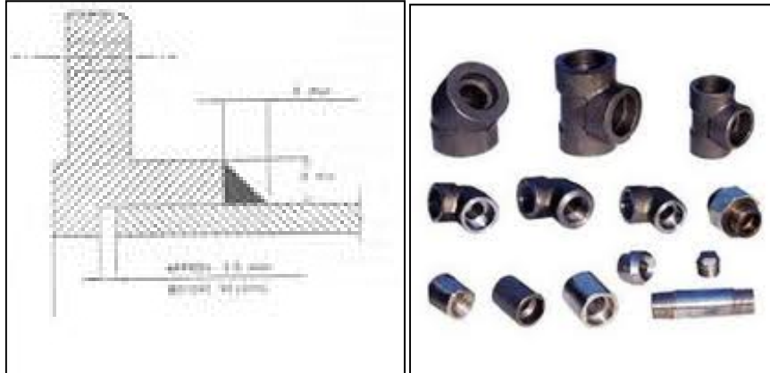
Εικόνα 2-9: Παράπλευρος ή socket welded (μορφή ραφής και εξαρτήματα)
