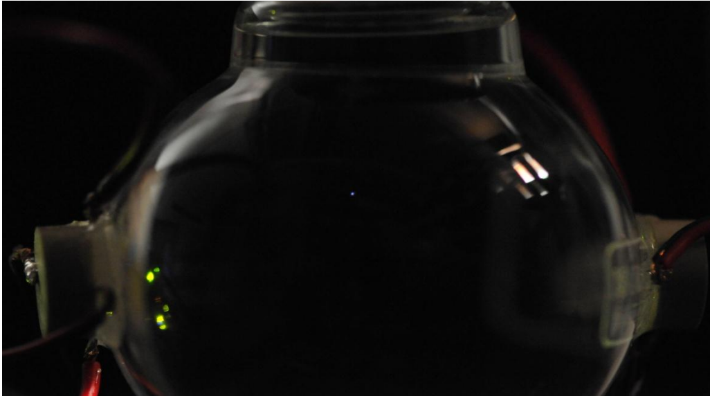
Σχήμα 4-8 Η φουσαλίδα όταν εκπέμπει φώς σε συσκοτισμένο δωμάτιο
