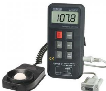
Εικόνα 6.1: Όργανο μέτρησης έντασης φωτισμού (EXTECH INSTRUMENTS, 401036, Datalogging Light Meter)
