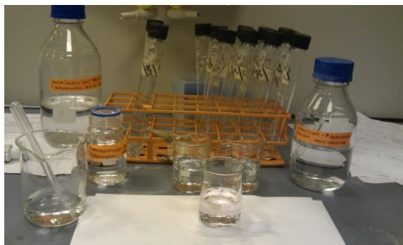
Σχήμα 3-15: Εξουδετέρωση του οξέος με προσθήκη NaOH
