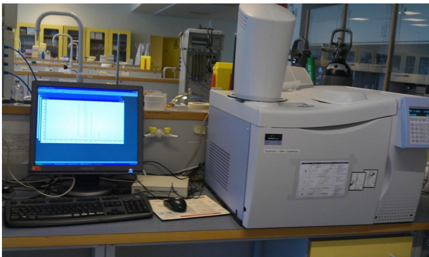
Σχήμα 3-5: Ο αέριος χρωματογράφος (GC) που χρησιμοποιήθηκε για τη μέτρηση της συγκέντρωσης των VFA
