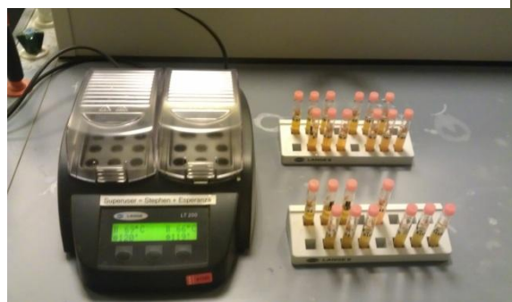
Σχήμα 3-3: Τοποθέτηση των κυψελίδων για χώνευση
