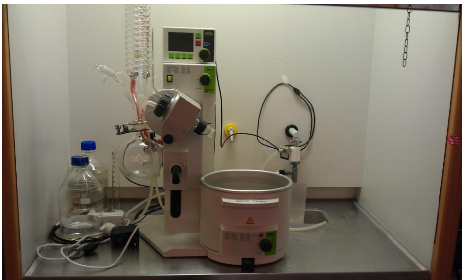
Σχήμα 3-19: Buchi Rotavapor-II with Buchi Vacuum Controller V-850 που χρησιμοποιήθηκε για την απόσταξη
