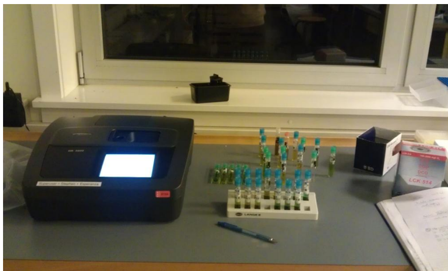
Σχήμα 3-7: Μέτρηση της απορρόφησης των κυψελίδων
