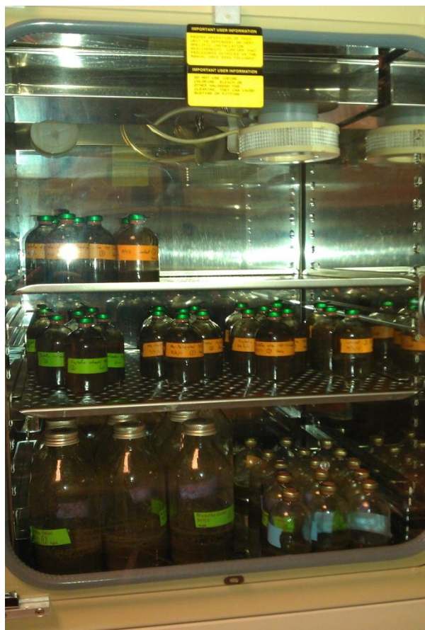
Σχήμα 3-21: Φιαλίδια για τα πειράματα methane potential που φυλάσσονται εντός του εκκολαπτηρίου
