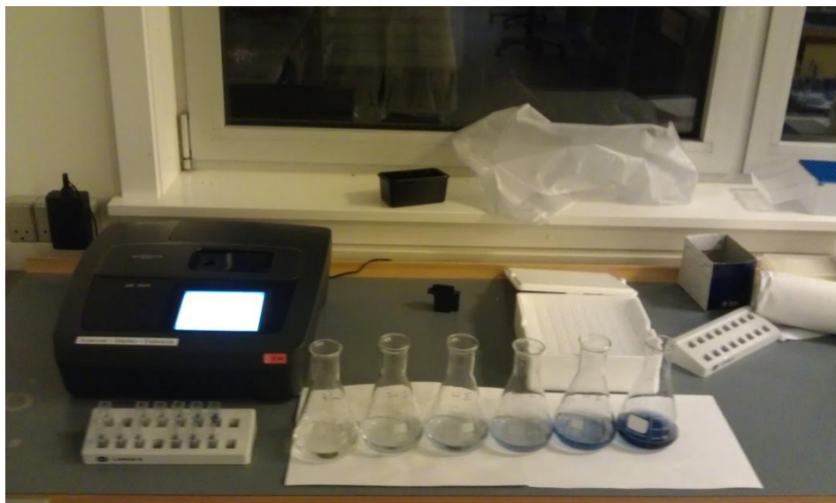
Σχήμα 3-16: Μέτρηση της απορρόφησης του blank και των standards
