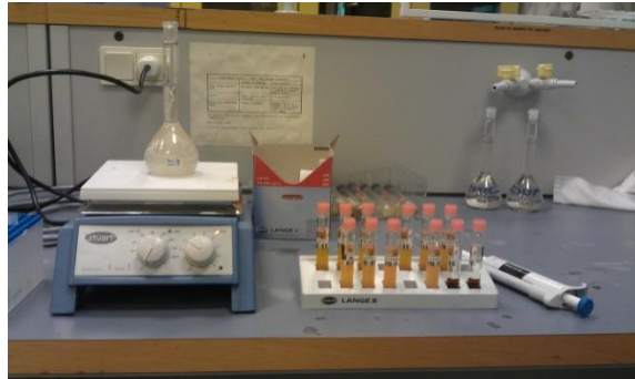
Σχήμα 3-2: Εξαγωγή δείγματος υπό συνθήκες πλήρους μίξης
