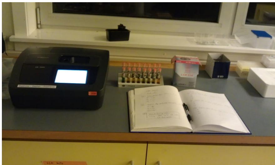
Σχήμα 3-4: Τοποθέτηση των κυψελίδων στο φωτόμετρο και καταγραφή της τιμής του COD
