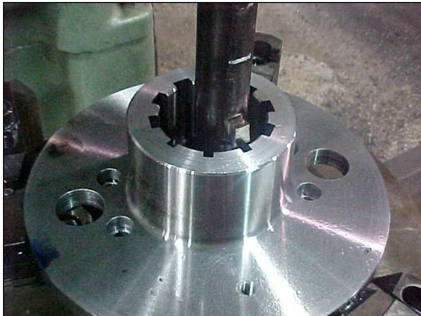
Σχήμα 1-14: Κοπή ακριβείας δέκα εσωτερικών αυλάκων σε εργαλειομηχανή κάθετου πλανίσματος (slotting machine) [φώτο από Franklin Machine & Gear Corporation - www.franklingear.com ].
