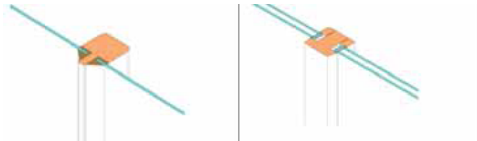
ΕΙΚΟΝΑ 4.15 ΓΡΑΜΜΙΚΗ ΣΤΗΡΙΞΗ ΥΑΛΟΠΙΝΑΚΩΝ Α) ΜΕ ΣΤΟΚΟ, Β) ΜΕ ΠΗΧΑΚΙ (Ref.3)
