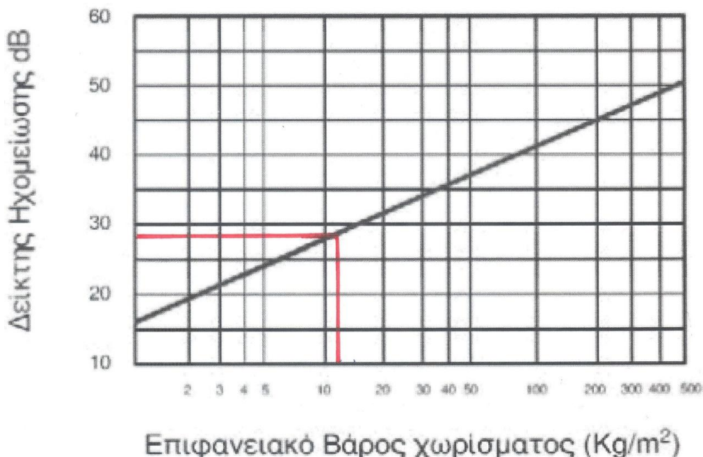
ΔΙΑΓΡΑΜΜΑ 11.1 ΠΡΟΣΕΓΓΙΣΤΙΚΟΣ ΜΕΣΟΣ ΔΕΙΚΤΗΣ ΗΧΟΜΕΙΩΣΗΣ ΜΟΝΩΝ ΧΩΡΙΣΜΑΤΩΝ ΜΕ ΒΑΣΗ ΤΟ ΝΟΜΟ ΤΗΣ ΜΑΖΑΣ (ΑΠΟΤΥΠΩΣΗ ΣΤΟ ΔΙΑΓΡΑΜΜΑ, ΕΠΙΦΑΝΕΙΑΚΟΥ ΒΑΡΟΥΣ 12,40\text{kg/m}^2 ΠΕΤΑΣΜΑΤΟΣ ΠΑΝΕΛΟΥ ΠΟΥΟΥΡΕΘΑΝΗΣ)
