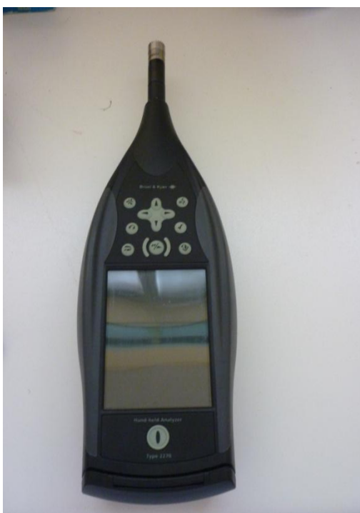
ΕΙΚΟΝΑ 7.13 ΗΧΟΜΕΤΡΟ, Sound Level Meter Brüel & Kjær, Hand-held Analyzer Type 2270.
