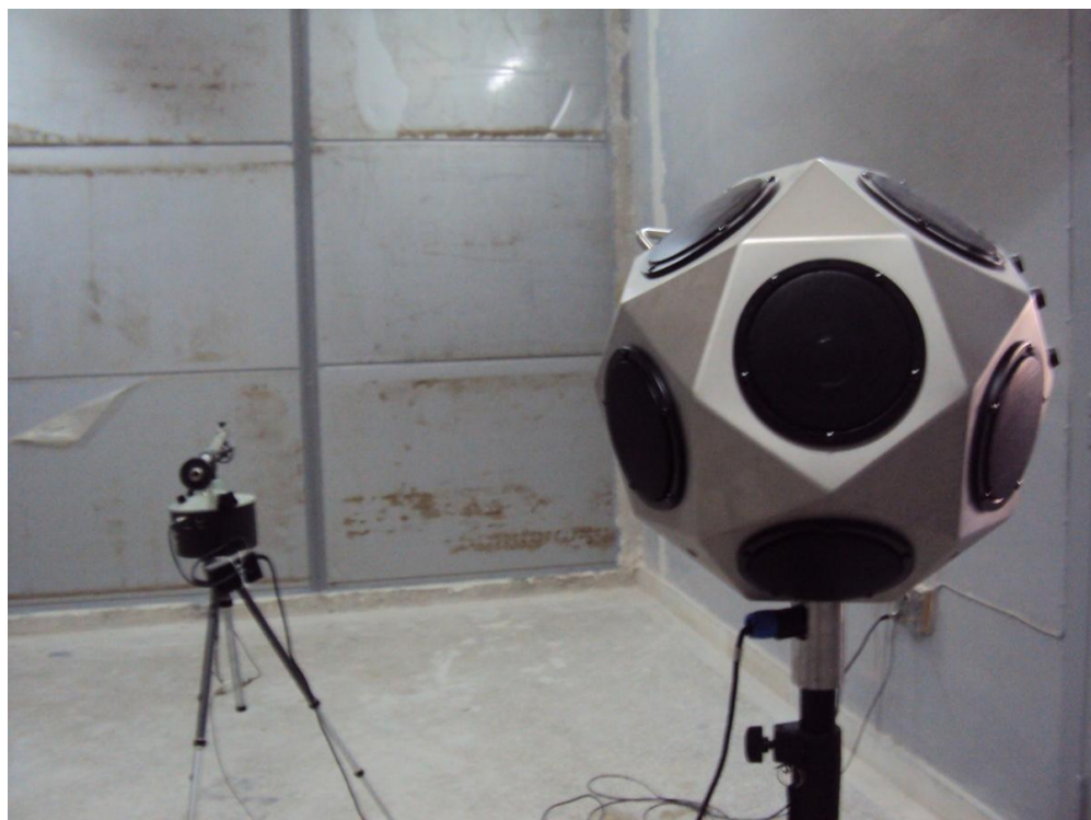
ΕΙΚΟΝΑ 7.12 ΜΕΤΡΗΣΗ L1 ΣΤΟ ΕΡΓΑΣΤΗΡΙΟ ΗΧΟΤΕΧΝΙΑΣ, ΣΧΟΛΗΣ ΑΡΧΙΤΕΚΤΟΝΩΝ Ε.Μ.Π.
