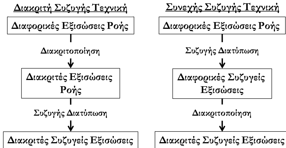
Σχήμα 4.1: Σύγκριση διακριτής (αριστερά) και συνεχούς (δεξιά) συζυγούς τεχνικής.
