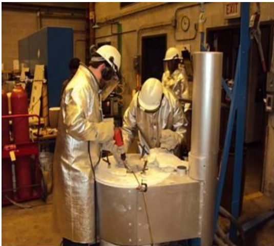
Εικόνα Β.66.α. Προσθήκη σωματιδίων ΙΤΚ στο υπό-ανάδευση τήγμα του κράματος Α356 ΑΙ.
