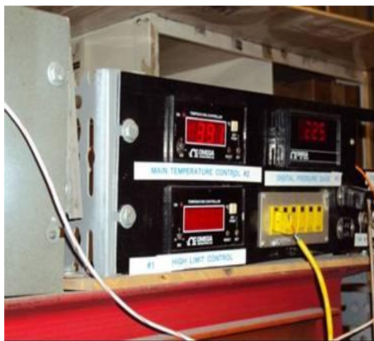
Εικόνα B.55.β. Απεικόνιση των τιμών πίεσης και θερμοκρασίας σε πραγματικό χρόνο.
