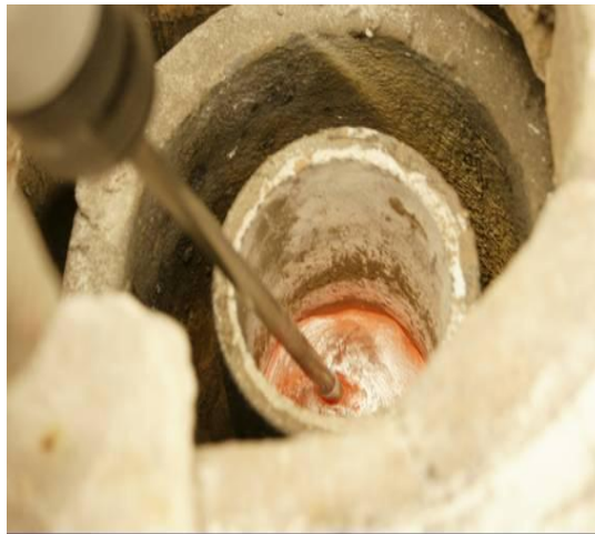
Εικόνα Β.66.β. Ανάμιξη τήγματος Α356 ΑΙ – σωματιδίων ιπτάμενων τεφρών.
