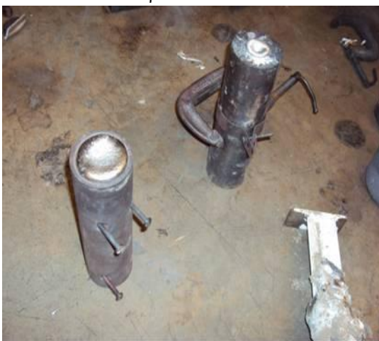
Εικόνα Β.66.ε. Στερεοποίηση συνθέτων Α356 ΑΙ – ΙΤΚ 10% σε κυλινδρικό καλούπι. Κάτω δεξιά: Υπόλειμμα της χύτευσης.
