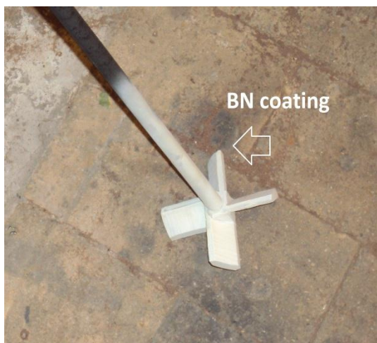
Εικόνα B.65.γ. Αναδευτήρας από γραφίτη που κατασκευάστηκε για τις ανάγκες της διδακτορικής διατριβής. Επικάλυψη με BN.
