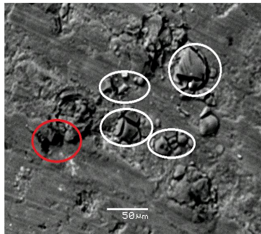
Εικόνα B23.β. Μικροφωτογραφία εντός του ίχνους φθοράς του δοκιμίου TC05. Επισημάνση των επιφανειακών σχηματισμών εντός ερυθρών και λευκών - κλίμακα: 50 μm.
