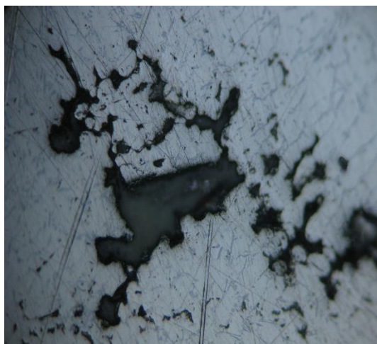
Εικόνα B.67.β. Επιφάνεια του συνθέτου SC-C01 (οπτικό μικροσκόπιο).
