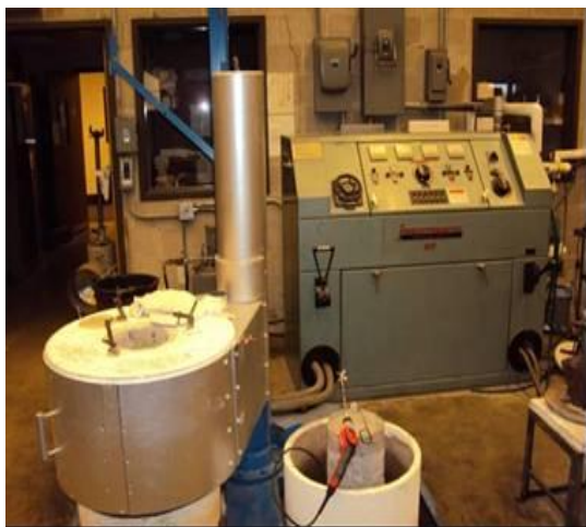
Εικόνα B.65.α. Διάταξη παρασκευής των συνθέτων υλικών A365 Al.
