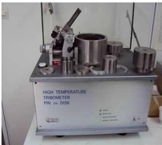
Εικόνα B18.α. Τριβόμετρο CSEM υψηλών θερμοκρασιών (ιδ. ΕΚΕΠΥ Α.Ε.).
