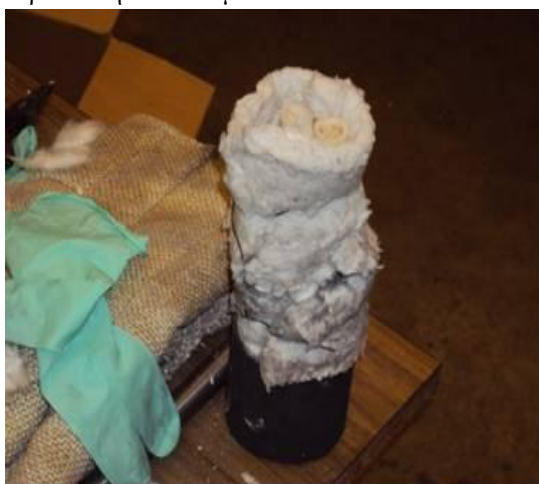
Εικόνα B.55.γ. Κάψουλα δοκιμών πρώτων υλών για την παρασκευή των δοκιμών PI-C01-PI-C08.
