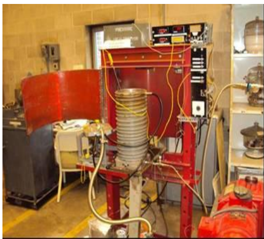
Εικόνα B.55.α. Τροποποιημένος φούρνος για την παρασκευή των δοκιμών PI-C01-PI-C08.
