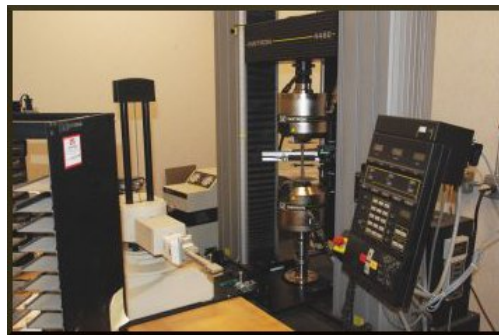
Εικόνα 3.4 Συσκευή δοκιμών συμπίεσης (Instron, 4482 testing apparatus, MA, USA).
