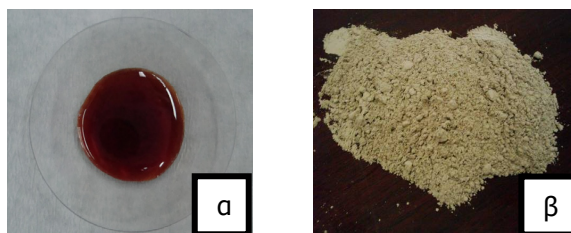
Εικόνα 2.2 α. Ρητίνη φαινόλης-φορμαλδεΐδης και β. Αλουμινούχο τσιμέντο.
