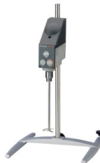
Εικόνα 2.4 Μηχανικός αναδευτήρας, Heidolph, RZR 2041, Germany.
