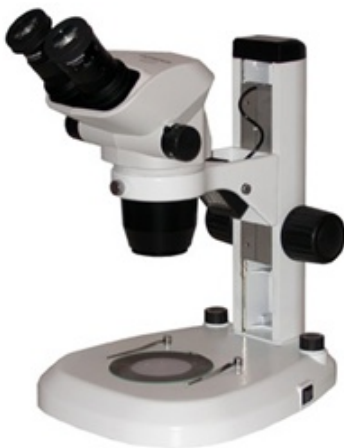
Εικόνα 4.3 Στερεοσκόπιο (Olympus, SZ61, Germany).
