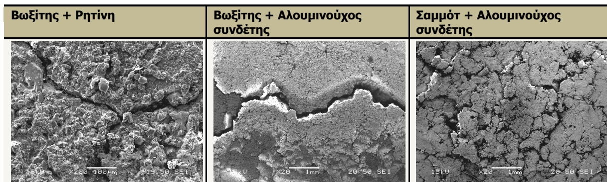
Εικόνα 4.6 Απεικονίσεις της επιφάνειας των δοκιμίων μετά από τη θερμική καταπόνηση για τους διαφορετικούς τύπους πυρίμαχων.
