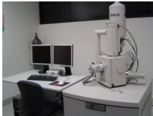
Εικόνα 2.8 Ηλεκτρονικό Μικροσκόπιο Σάρωσης (FEI, Quanta 200 ,2004, OR, USA).
