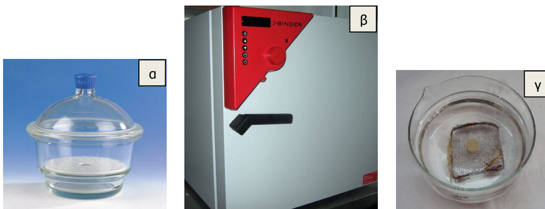
Εικόνα 4.5 Απαιτούμενος εργαστηριακός εξοπλισμός για τη διεξαγωγή πειραμάτων υδατοαπορρόφησης και συγκεκριμένα α. ξηραντήρας, β. εργαστηριακός φούρνος και γ. ποτήρι ζέσεως με μεταλλικό πλέγμα.
