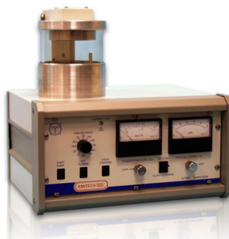
Εικόνα 2.9 Επιμεταλλωτής SC7620 Mini Sputter Coater (Quorum Technologies, West Sussex, UK).
