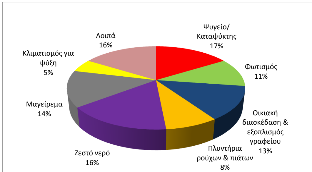
Σχήμα 3.1 Τυπική χρήση της ηλεκτρικής κατανάλωσης ανά τελική χρήση στον οικιακό τομέα στην Ελλάδα (2010)
