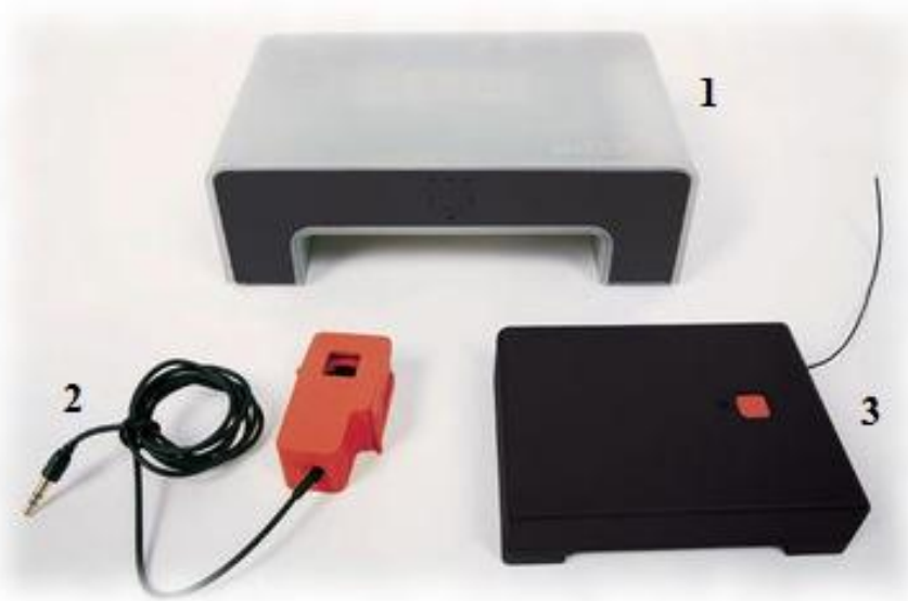
Σχήμα 4.1 Ο μετρητής ηλεκτρικής ενέργειας Wattson (1), ο ακροδέκτης μέτρησης (2) και ο ασύρματος αποστολέας μετρήσεων (3)
