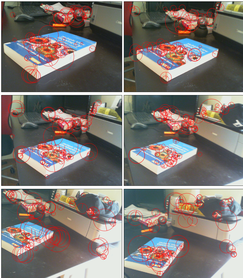
Σχήμα 5.9: Αριστερά προς δεξιά: Τοπικά χαρακτηριστικά SURF σε επιλεγμένα διαδοχικά καρέ. Με κόκκινο χρώμα παρουσιάζονται τα inliers του κάθε καρέ.
