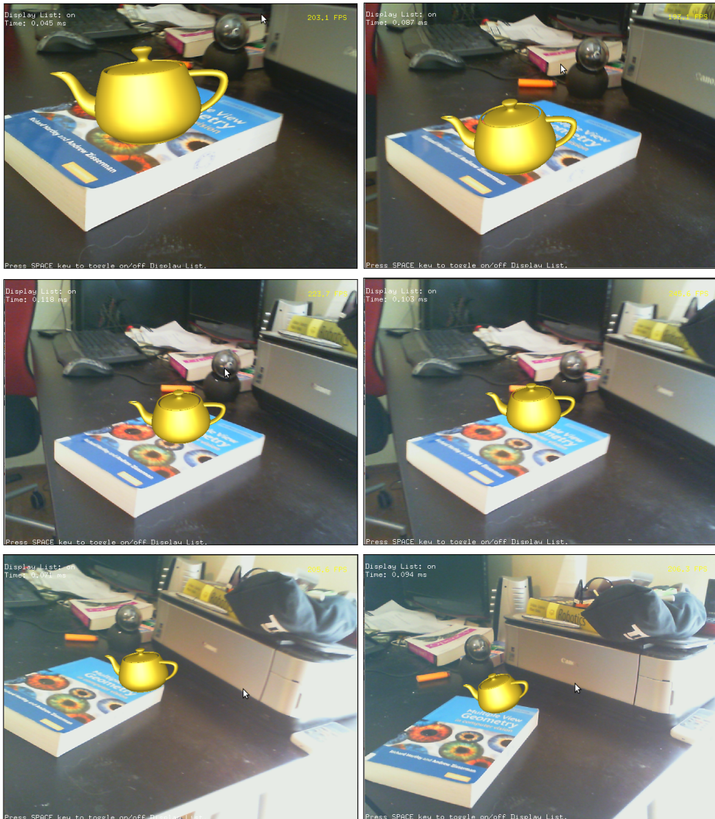
Σχήμα 5.12: Αριστερά προς δεξιά: Η προβολή του γραφικού μοντέλου στη σκηνή. Η εκτίμηση θέσης της κάμερας έγινε χρησιμοποιώντας τοπικά χαρακτηριστικά BRISK.
