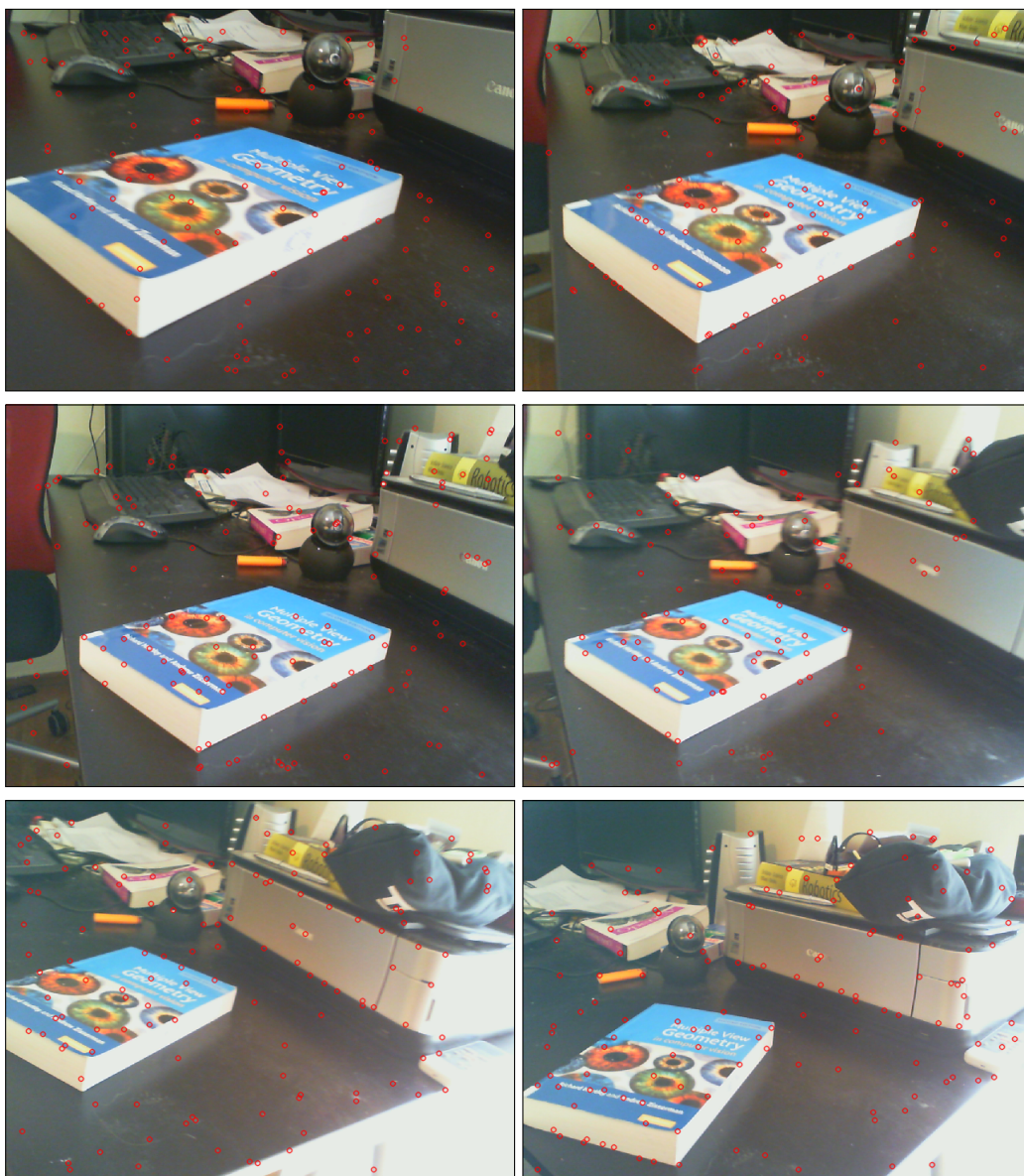
Σχήμα 5.7: Αριστερά προς δεξιά: Τοπικά χαρακτηριστικά LibViso2 σε επιλεγμένα διαδοχικά καρέ. Με κόκκινο χρώμα παρουσιάζονται τα inliers του κάθε καρέ.
