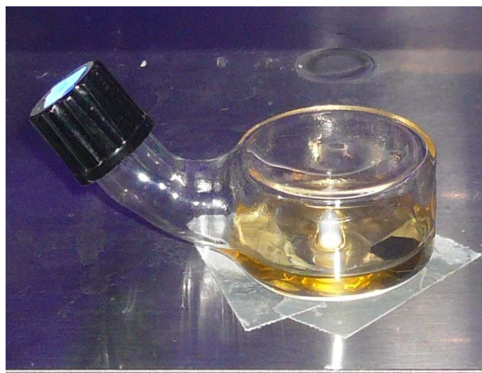
Εικόνα 5-5 Το ειδικό σκεύος που χρησιμοποιήθηκε για την ακτινοβόληση των δειγμάτων στον αντιδραστήρα.
