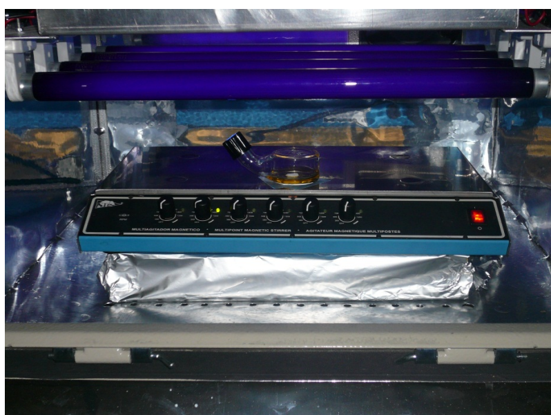
Εικόνα 5-6 Ο ειδικός αντιδραστήρας που χρησιμοποιήθηκε για την ακτινοβόληση των δειγμάτων.
