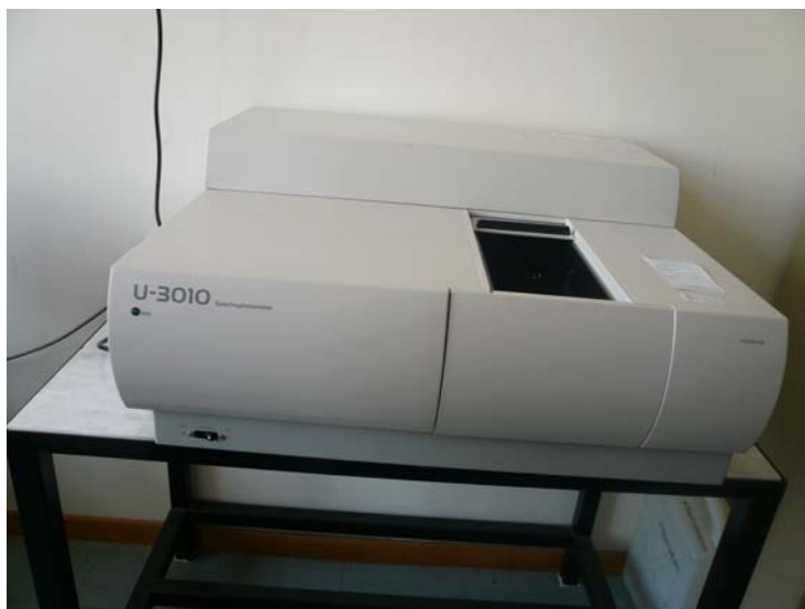
Εικόνα 5-6 Διάταξη οπτικού φασματοφωτόμετρου Hitachi U-3010
