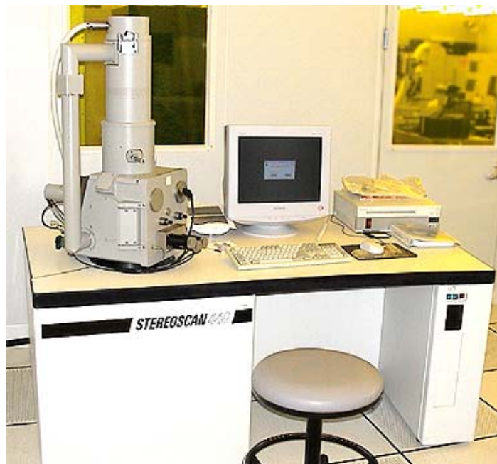
Εικόνα 5-2 Ηλεκτρονικό Μικροσκόπιο Σάρωσης LEICA S440
