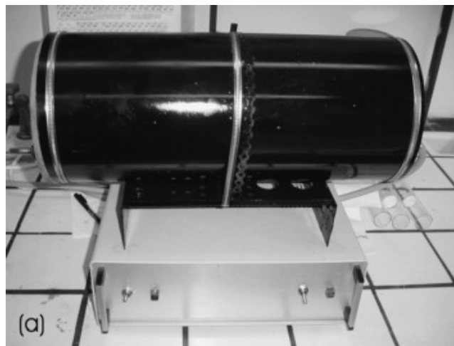
Εικόνα 4-4 Περιβαλλοντικός φωτοκαταλυτικός αντιδραστήρας κλειστού τύπου με δέκα λάμπες UV (1) στον περιβάλλοντα χώρο και δύο ανεμιστήρες (2) για σταθεροποίηση της θερμοκρασίας περιβάλλοντος. Ο φωτοκαταλύτης (4) τοποθετείται εντός υάλινης κυψελίδας Pyrex (3) διαστάσεων 1\text{dm}^3 τοποθετημένης στο κέντρο της βάσης του αντιδραστήρα που τροφοδοτείται με μείγμα αέριων ρύπων. Αγωγός εξόδου επιτρέπει την δειγματοληψία.
