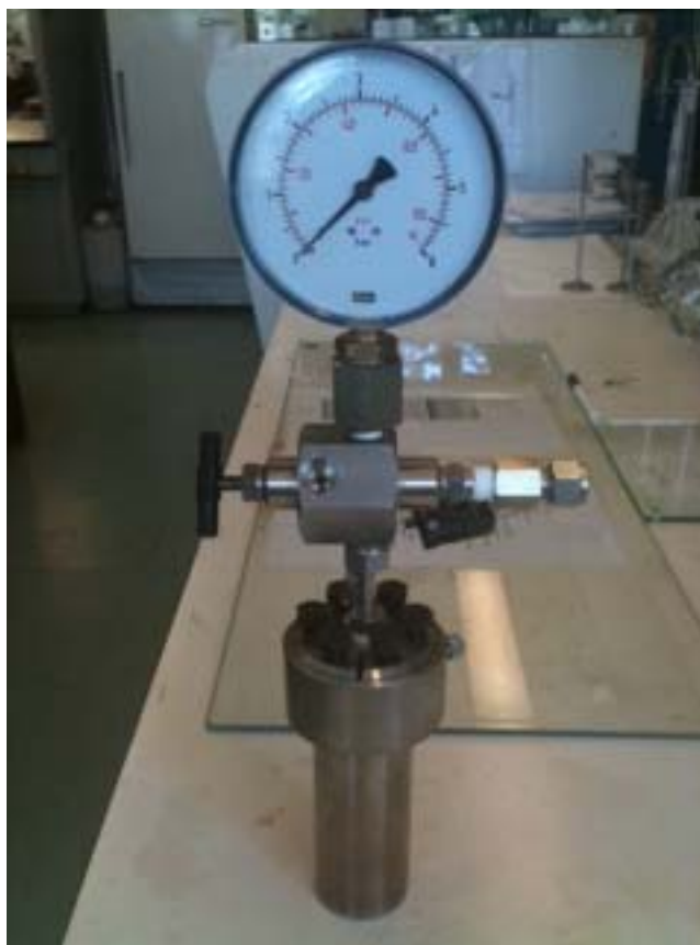
Εικόνα 5-1 Το αυτόκλειστο που χρησιμοποιήθηκε για την υδροθερμική κατεργασία.
