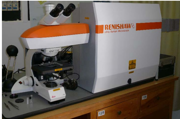
Εικόνα 5-5 Φασματόμετρο διασποράς Renishaw Invia- Reflex του εργαστηρίου Raman του Ινστιτούτου φυσικοχημείας του Ε.Κ.Ε.Φ.Ε. «Δημόκριτος».
