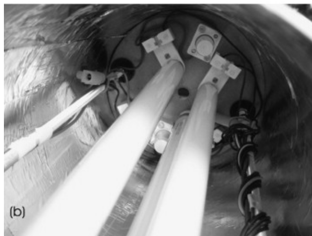
Εικόνα 4-5 Φωτοκαταλυτικός αντιδραστήρας αέριων ρύπων συνεχούς ροής. Εξωτερική (a) και εσωτερική (b) άποψη.
