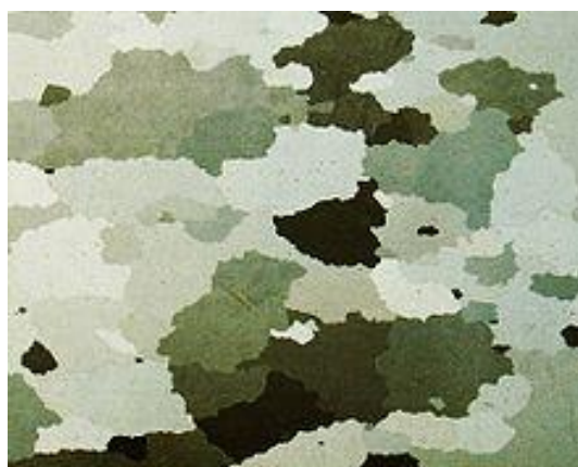
Εικόνα 2.1: Συνήθης μικροδομή που απαντάται σε ηλεκτρικούς χάλυβες μη προσανατολισμένων κόκκων.
