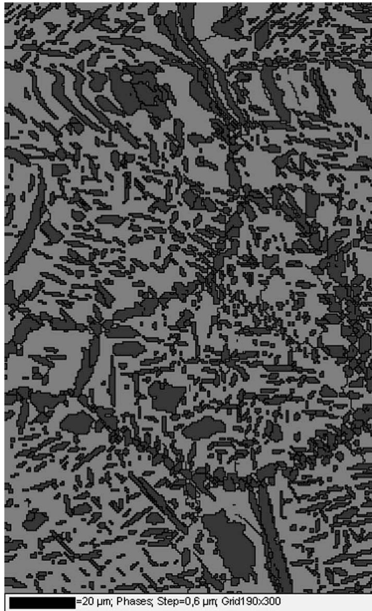
Εικόνα 33 – Χάρτης φάσεων EBSD της περιοχής της εικόνας 32. Φερρίτης (γκρι ανοιχτόχρωμο) και ωστενίτης (γκρι σκούρο). Δοκίμιο πάχους 4 mm.
