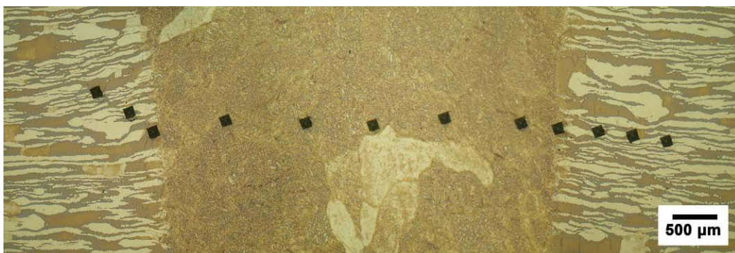
Εικόνα 44 – Ίχνη των μετρήσεων μικροσκληρότητας στην μικροδομή της συγκόλλησης μετά από επιφανειακή κατεργασία με δέσμη ηλεκτρονίων.
