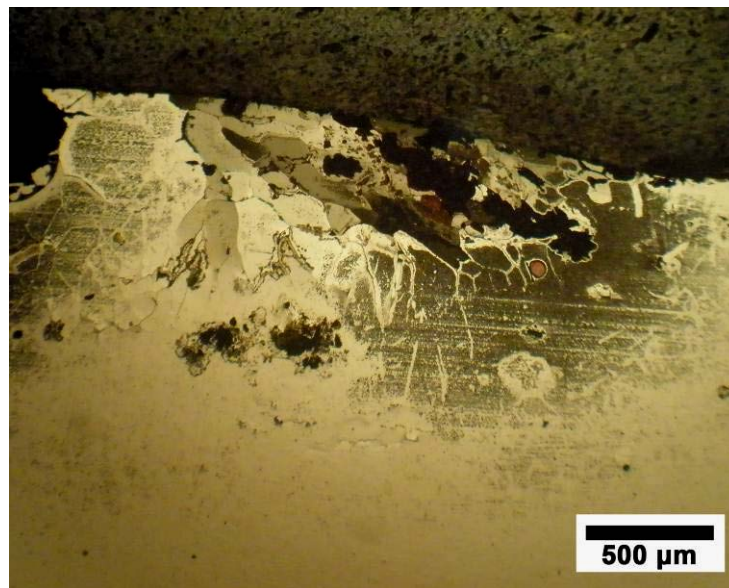
Εικόνα 72 – Δοκίμιο ST1, συγκόλληση πάχους 4 mm μετά από επιφανειακή κατεργασία με δέσμη ηλεκτρονίων. Άποψη σε δυο μέρη του ανώτερου τμήματος της συγκόλλησης (κάλυμμα φερρίτη) όπου διακρίνεται εκτεταμένη διάβρωση.
