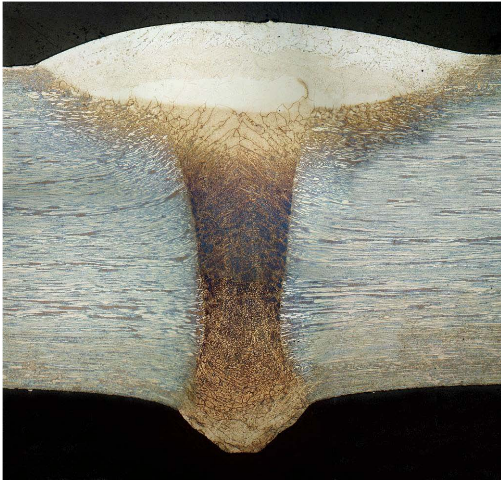
Εικόνα 25 – Συγκόλληση μετά από επιφανειακή κατεργασία δέσμης ηλεκτρονίων. Πάχος υλικού 4 mm.
