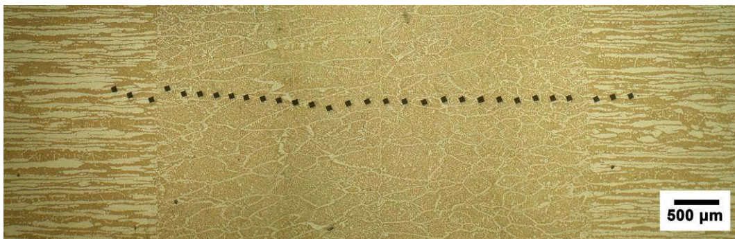
Εικόνα 43 – Ίχνη των μετρήσεων μικροσκληρότητας στην μικροδομή της συγκόλλησης μετά από θερμική κατεργασία.
