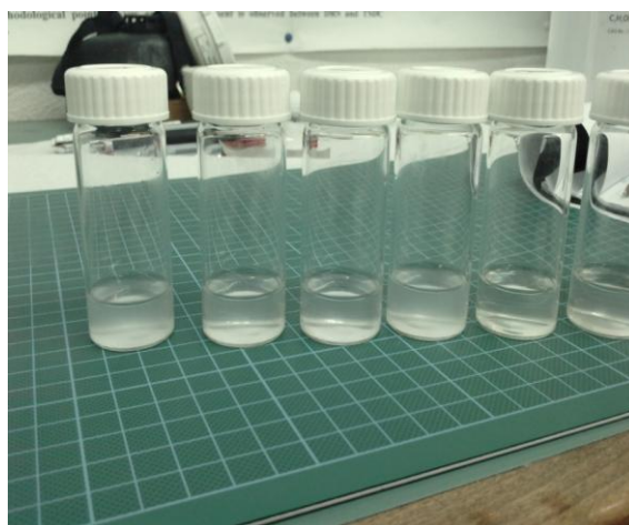
Εικόνα 5.1: Φιαλίδια που χρησιμοποιήθηκαν στην μέθοδο immersion . Αριστερά βρίσκεται η καθαρή PU με εμφανή θόλωση του νερού.
