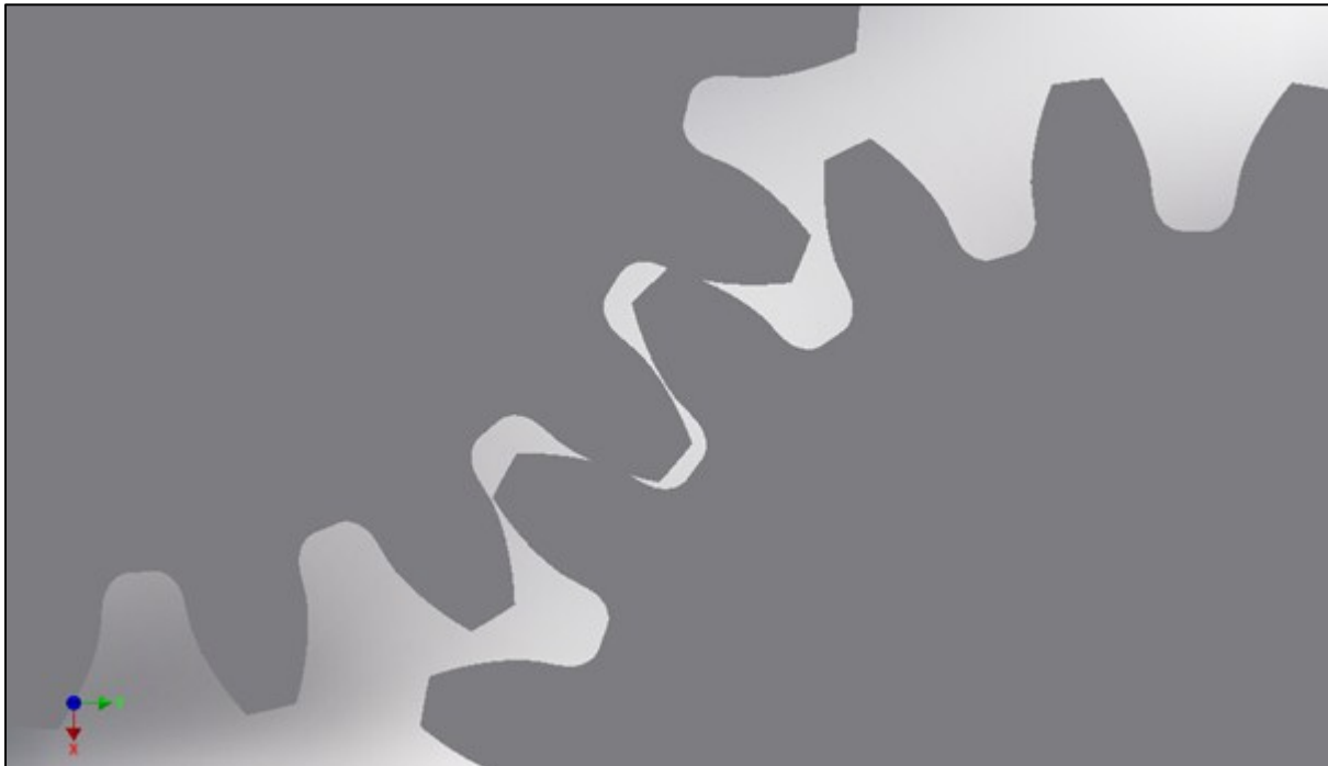
Σχήμα 2.7: Μετωπικοί οδοντωτοί τροχοί ευθείας οδοντώσεως σε συνεργασία - Εστίαση στα συνεργαζόμενα ζεύγη οδοντώσεων
