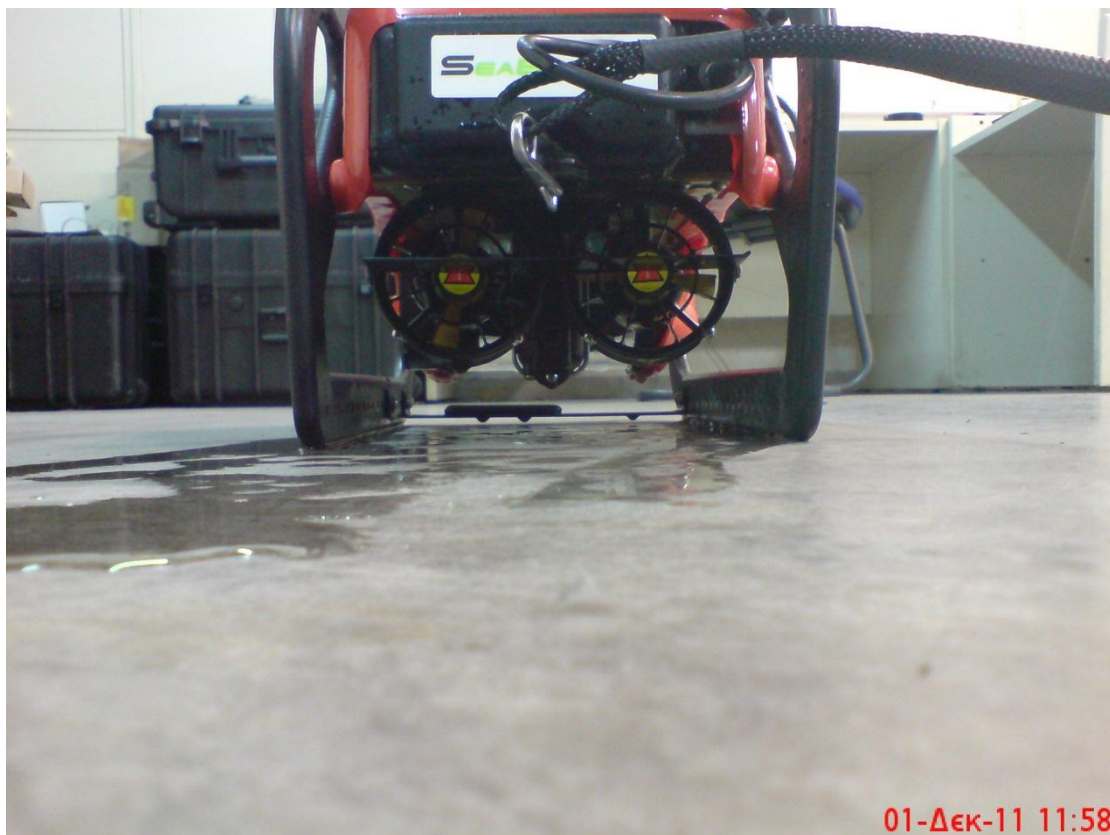
Σχήμα 2.5.1: Διάταξη κινητήρων (Port & Starboard thrusters)
