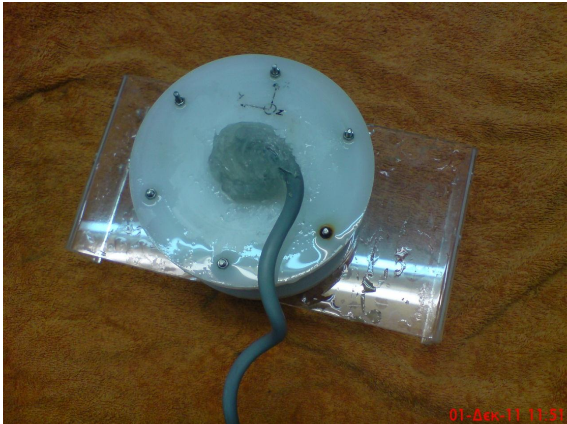
Σχήμα 2.8: Δοχείο τοποθέτησης Mti, τοποθετημένο σταθερά πάνω στην ειδική βάση
