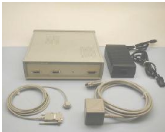
Σχήμα 2.6: Σύστημα θέσης και προσανατολισμού Isotrak II
