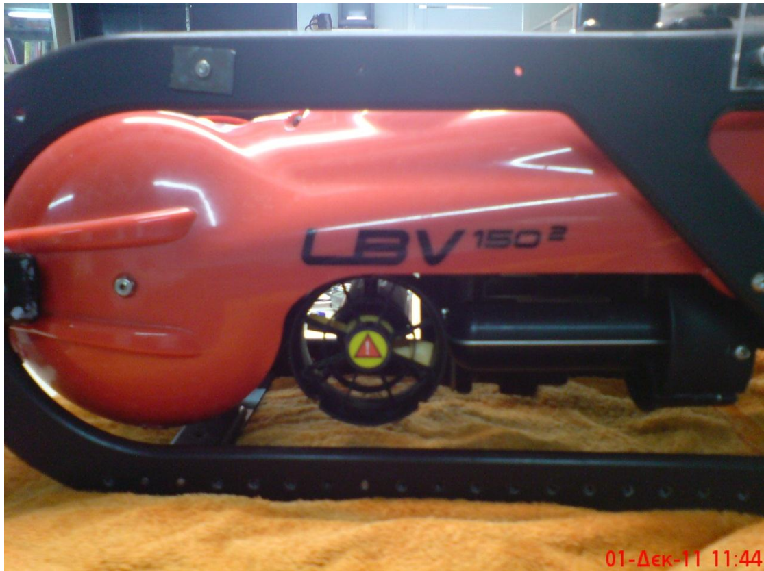
Σχήμα 2.5.2: Διάταξη κινητήρων (Lateral thruster)
