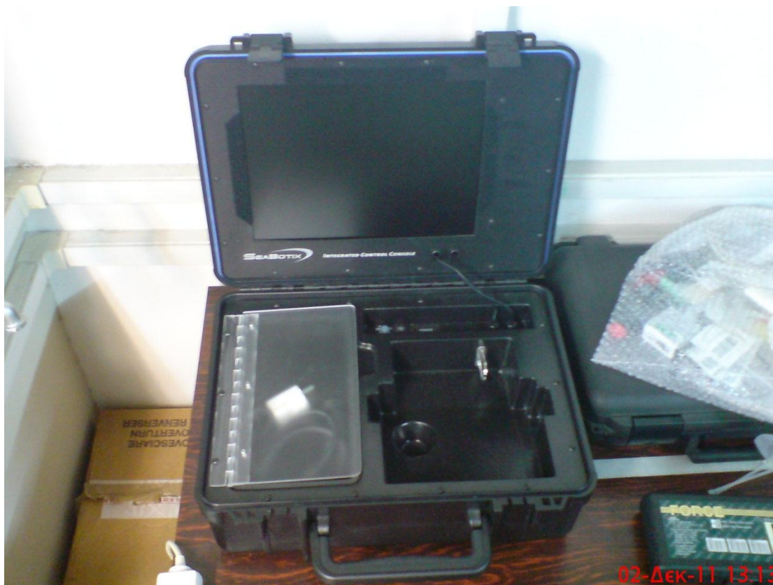
Σχήμα 2.2: Κονσόλα ελέγχου LBV-150
