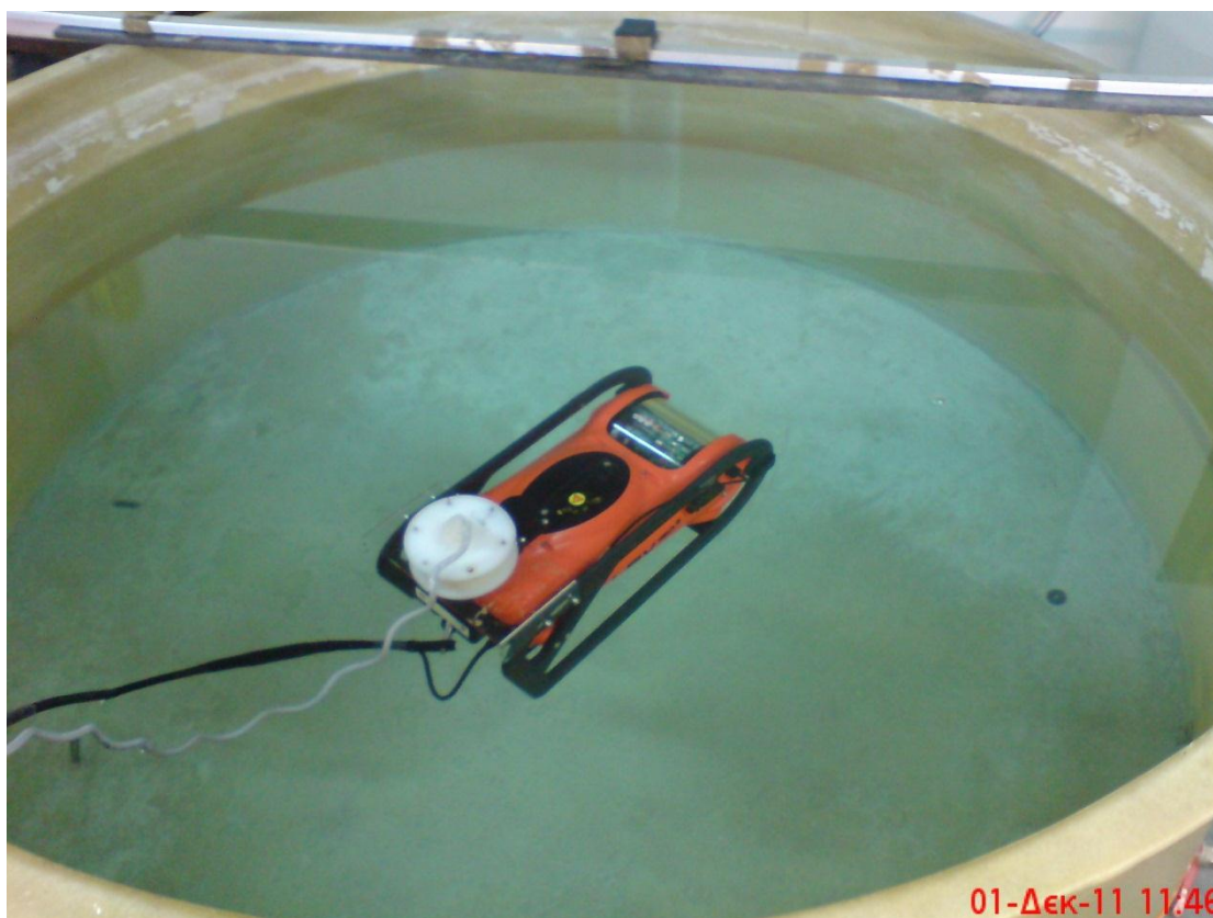
Σχήμα 2.1: Το υποβρύχιο όχημα LBV 150 στην δεξαμενή του Εργαστηρίου Αυτομάτου Ελέγχου
