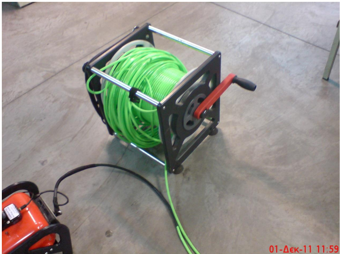
Σχήμα 2.4: Καλώδιο (tether) οχήματος για την μεταφορά δεδομένων
