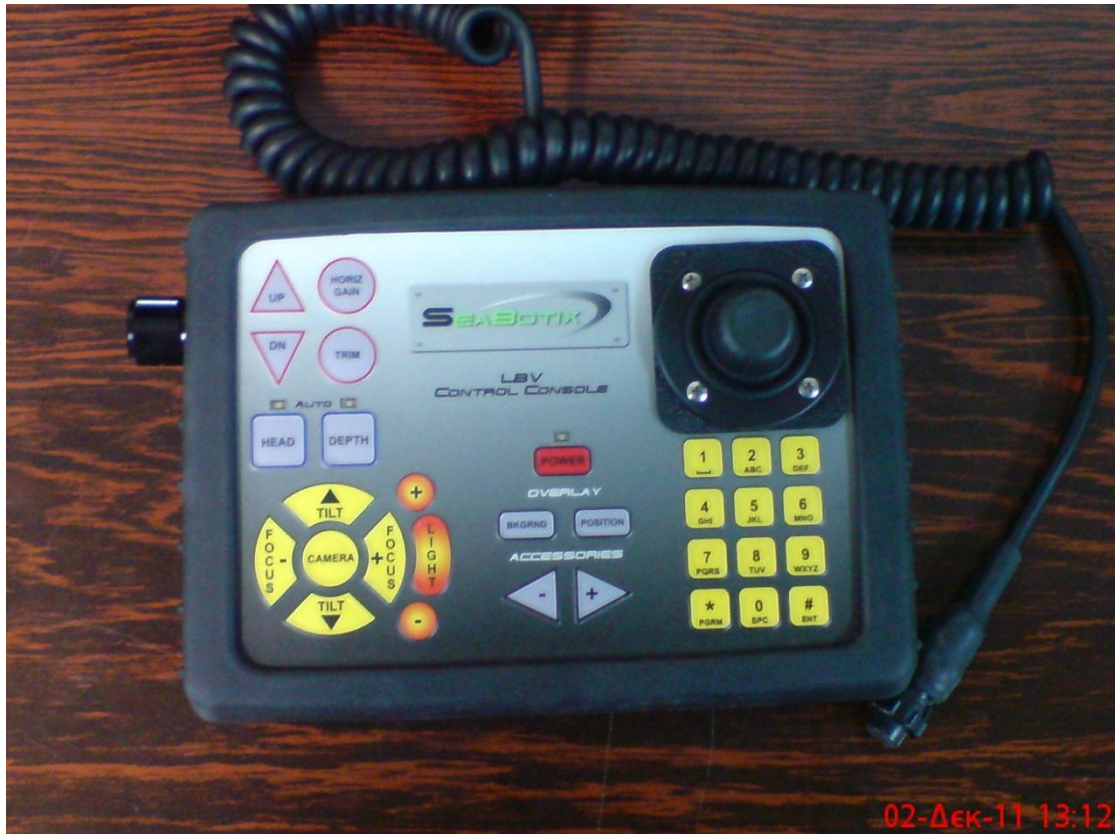
Σχήμα 2.3: Joystick ελέγχου LBV-150
