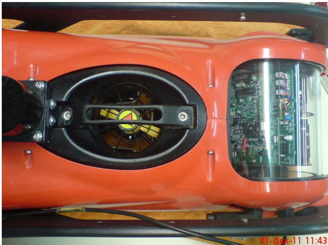
Σχήμα 2.5.3: Διάταξη κινητήρων (Vertical thruster)
