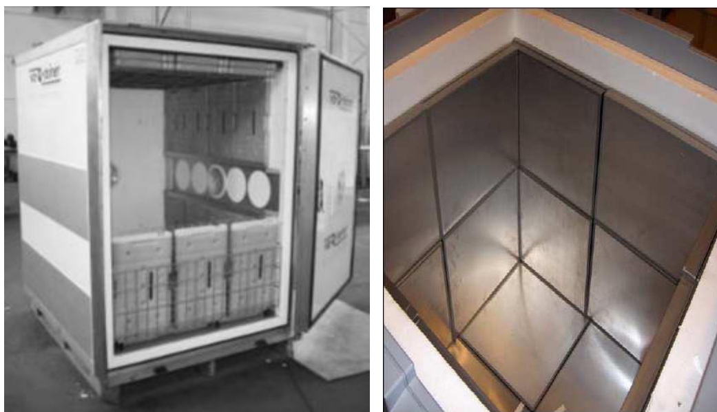
Εικόνα 2.20 : Θάλαμοι μεταφοράς με μόνωση PCM για σταθεροποίηση της θερμοκρασίας
