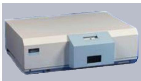
**Σχήμα 2.14:** Φασματοφωτομετρική διάταξη του εργαστηρίου
