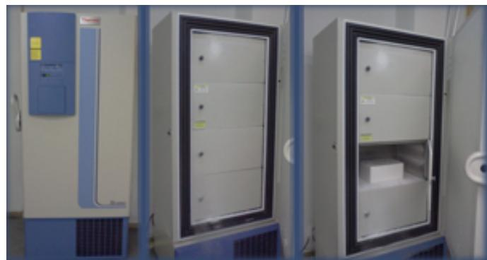
**Σχήμα 2.4:** Καταψύκτης σε θερμοκρασία  $-80^{\circ}\text{C}$
