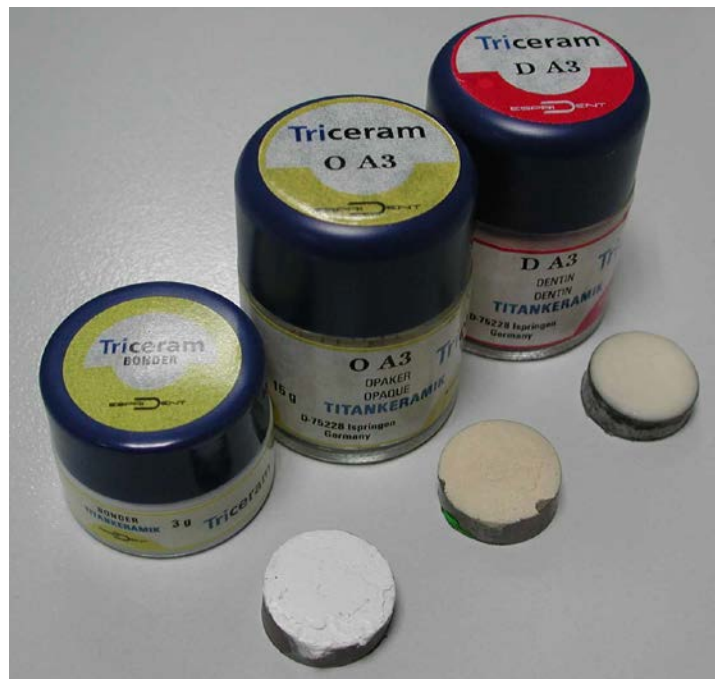
Εικόνα 64. Συσκευασία με τις σκόνες της πορσελάνης και δοκίμια που προετοιμάστηκαν για την ανάλυση με περίθλαση ακτίνων X για την πορσελάνη Triceram.
