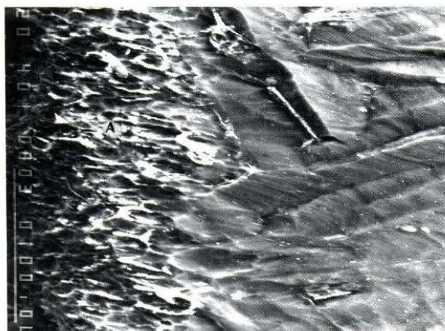
Εικόνα 59. Εγκάρσια διατομή δοκιμίου Ti χυτευμένου σε πυροχώμα φωσφορικού τύπου. Φαίνεται η χαρακτηριστική δομή της επιφανειακά μολυσμένης ζώνης (Περιοχή A: SEI ένδειξη κλίμακας 100μm). (Από Ζηνέλης και συν, 1998).
