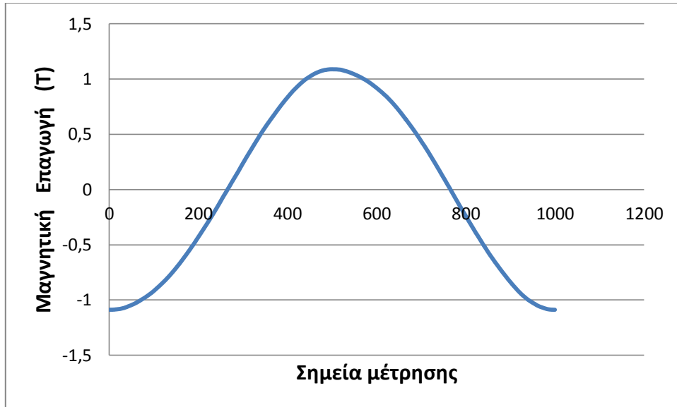
Σχήμα 3.12: Υπολογισμός μαγνητικής επαγωγής, για μία περίοδο, από τις τιμές τάσης (τάση εισόδου: 50Hz-3.3V).
