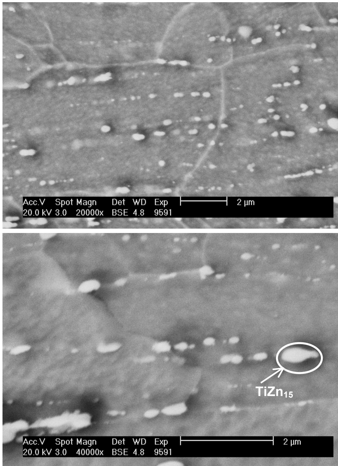
Εικόνα 39: Κατακρημνίσματα της μεσομεταλλικής ένωσης TiZn 15 σε μεγάλη μεγέθυνση. Τα σωματίδια είναι διεσπαρμένα, κατά τη διεύθυνση της έλασης, χωρίς να είναι συσσωματωμένα. Είναι ορατά τα όρια των κόκκων. Εικόνα από τον ανιχνευτή οπισθοσκεδαζόμενων ηλεκτρονίων (BSE Detector)
