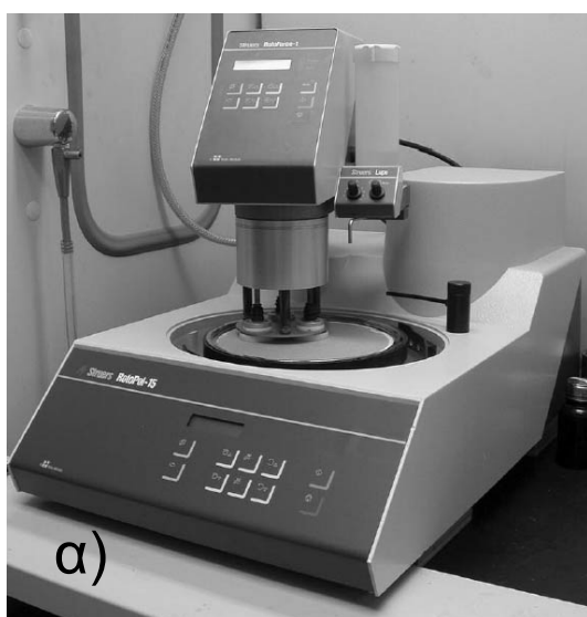
Εικόνα 9: Συσκευές που χρησιμοποιήθηκαν κατά την προετοιμασία των μεταλλογραφικών δειγμάτων. α) Ημιαυτόματη συσκευή λείανσης - στίλβωσης Struers Rotorol-15, β) Συσκευή ψυχρού εγκιβωτισμού Struers Citovac
