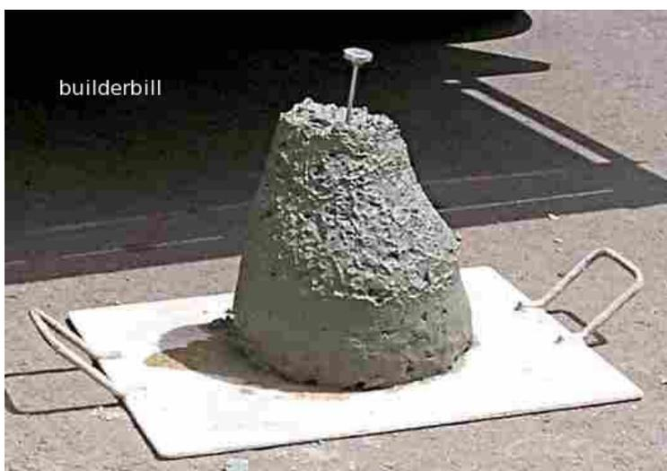
*Εικόνα 2.8: Τυποποιημένη δοκιμή τσιμέντου*
