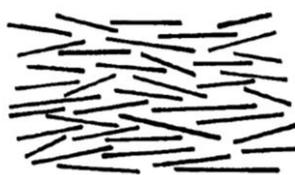
Σχήμα 1.7: Διάταξη αργιλικών πλακιδίων
