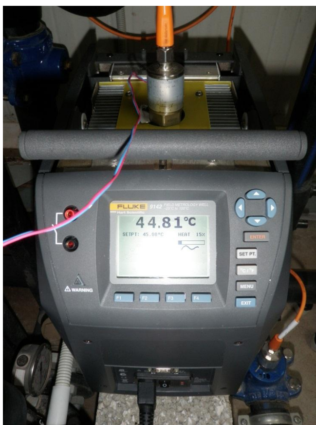
Εικόνα 6.2.3 Το Fluke 9142 σε λειτουργία κατά τη διαδικασία της βαθμονόμησης
