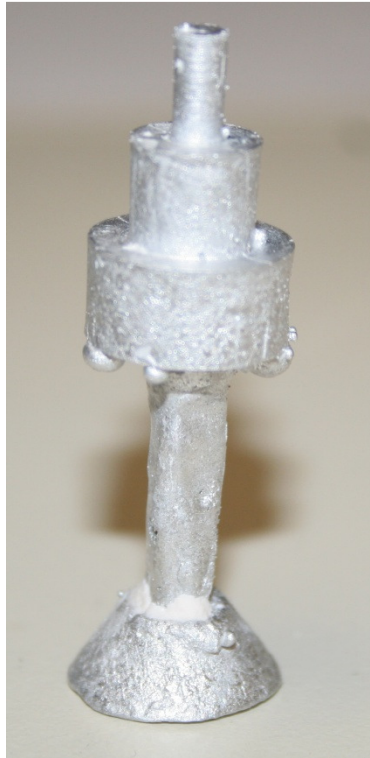
Εικόνα 67: Ατέλειες λόγω φυσαλίδων
