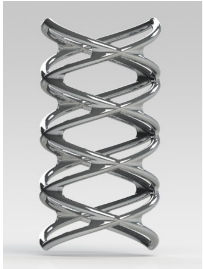
Εικόνα 4: Κύλινδρος κατασκευασμένος από δομικά στοιχεία τύπου πλέγματος
