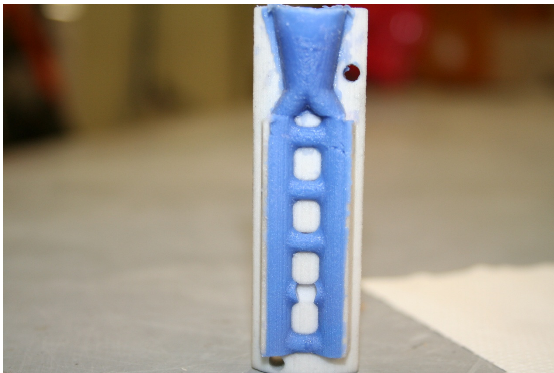
Εικόνα 55: Τεμάχιο με ατελή πλήρωση
