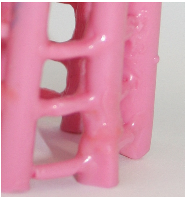
Εικόνα 53: Ατέλειες λόγω της κόλλησης του κεριού
