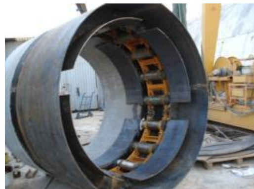
Εικόνα 3. 24: Ενδιάμεσος σταθμός ώθησης (12)
