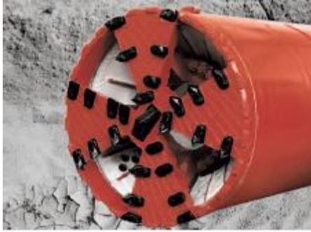
Εικόνα 1. 27: Κεφαλή σχεδιασμένη για μαλακά εδάφη (7)
