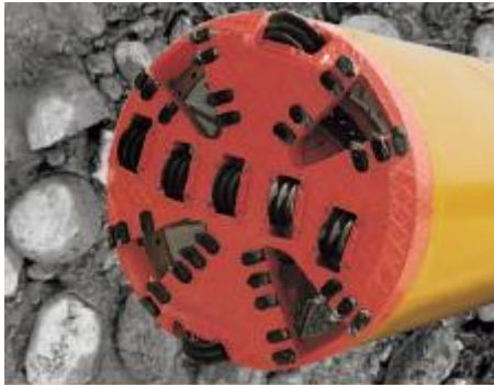
Εικόνα 1. 26: Κεφαλή σχεδιασμένη για μικτές συνθήκες (7)
