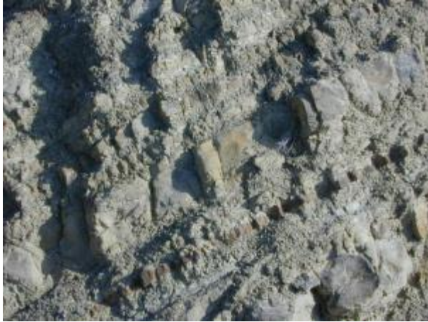
Εικόνα 3. 9: Εναλλαγές λεπτοστρωματοδών ψαμμιτών και ιλυολίθων (fl) του φλύσχη, περί τη Χ.Θ. 25+100 (25)
