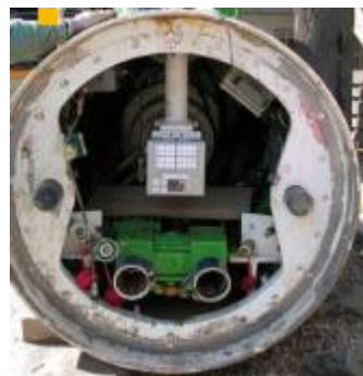
Εικόνα 1. 33: Γυροσκοπική πυξίδα τοποθετημένη στην θέση της στο κέντρο της ασπίδας.
