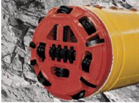
Εικόνα 1. 25: Κεφαλή σχεδιασμένη για βράχο με υψηλή αντοχή (7).
