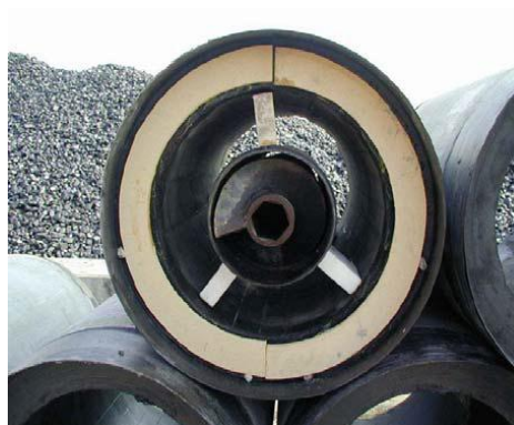
Εικόνα 1. 17: Σωλήνας τελικής επένδυσης με σωλήνωση (Casing) και κοχλία στο εσωτερικό του.
