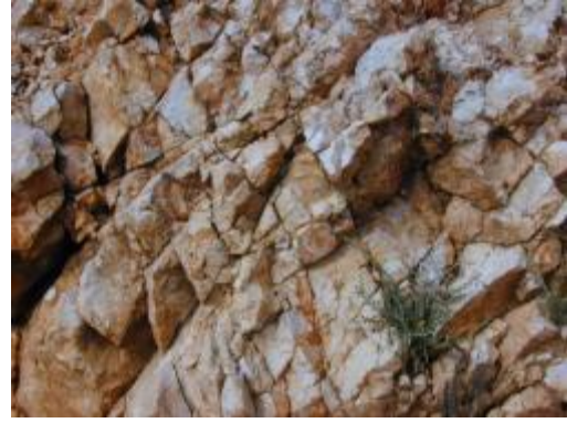
Εικόνα 3. 4: Λεπτομέρεια των κατακερματισμένων ασβεστόλιθων του Παντοκράτορα (ka.f) περί τη Χ.Θ. 27+700 (25)
