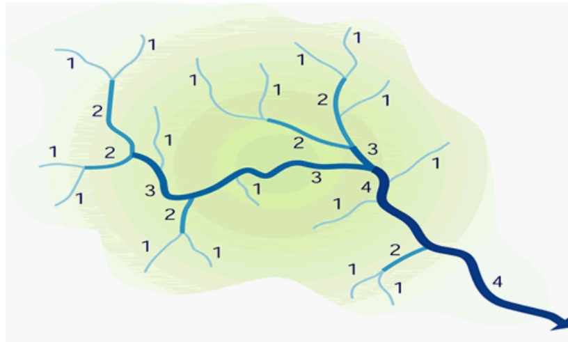
Σχήμα 3.9: Σχηματική αναπαράσταση της τάξης υδρογραφικού δικτύου κατά Strahler (State University of New York College of Environmental Science and Forestry)
