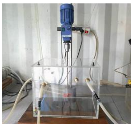
Εικόνα 3.9: Ανοξική 15,5 L (ANO15.5L) με οπή για να διέρχεται ο άξονας του αναδευτήρα και οι στροφές είχαν ρυθμιστεί ανάλογα.
