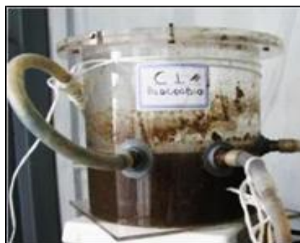
Εικόνα 3.6: Αναερόβια δεξαμενή - Ana2.4L
