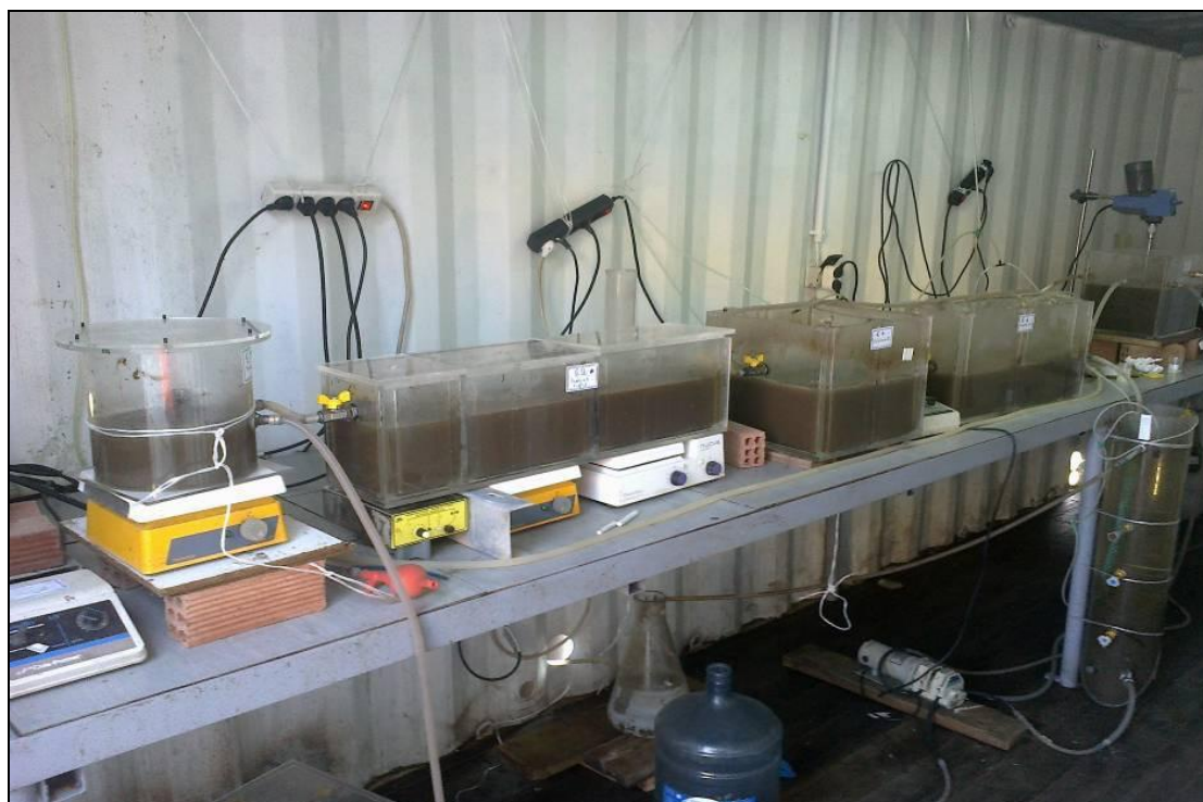
Εικόνα 3.2: Το ΠΣ κατά τη Β' Φάση λειτουργίας. Στο βάθος φαίνεται η ανοξική δεξαμενή του ΣΕ, ενώ η συνολική του εικόνα δεν διαφοροποιείται από το ΣΕ της Εικόνας 3.1.
