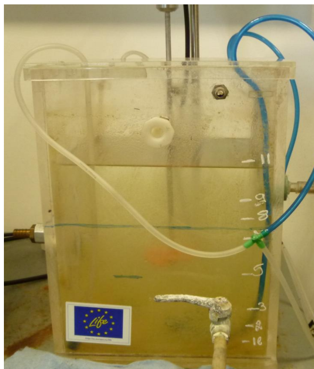
Εικόνα 3.2 Αναερόβιος - Αερόβιος αντιδραστήρας
