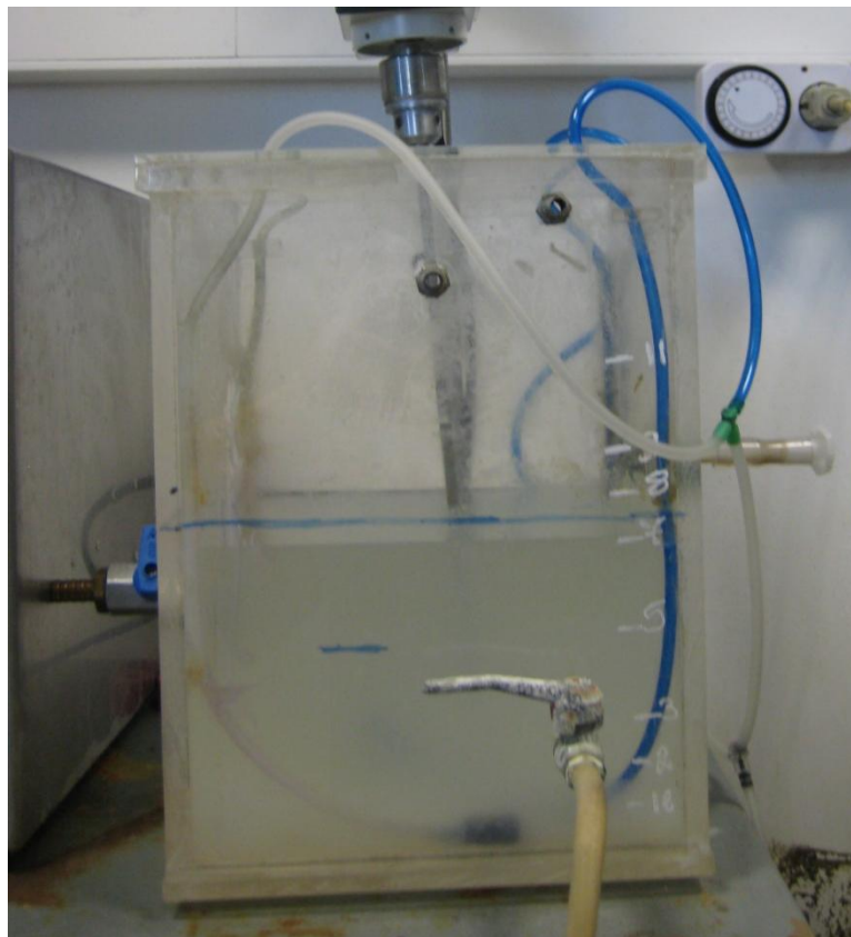
Εικόνα 4.2 Εικόνα αναερόβιου – αερόβιου κατά τη κανονική λειτουργία του (φάση καθίζησης)
