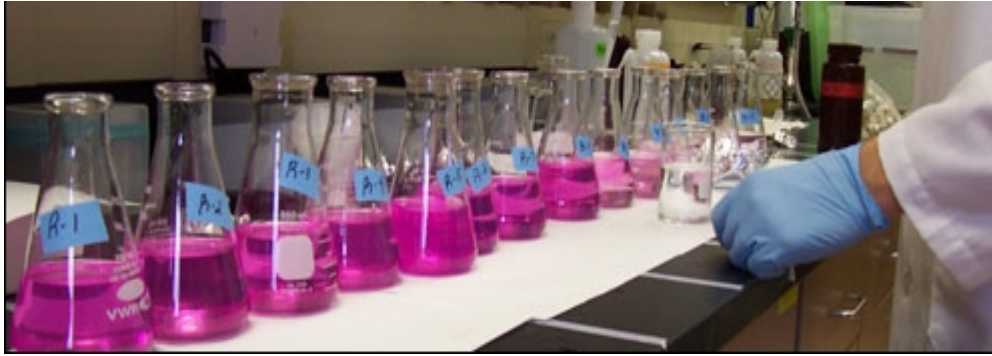
Εικόνα 3.5: Διαδικασία χώνευσης (πηγή: προσωπικό αρχείο)
