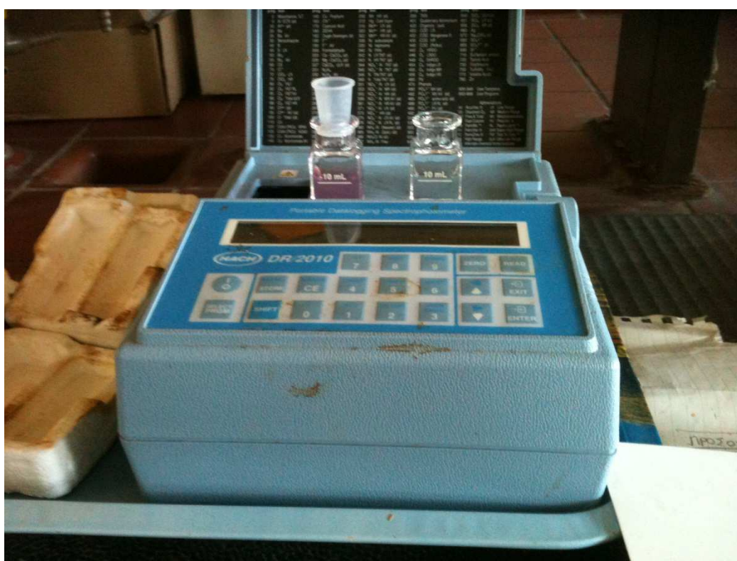
Σχήμα 7: Φασματοφωτόμετρο DR 2010 HACK
