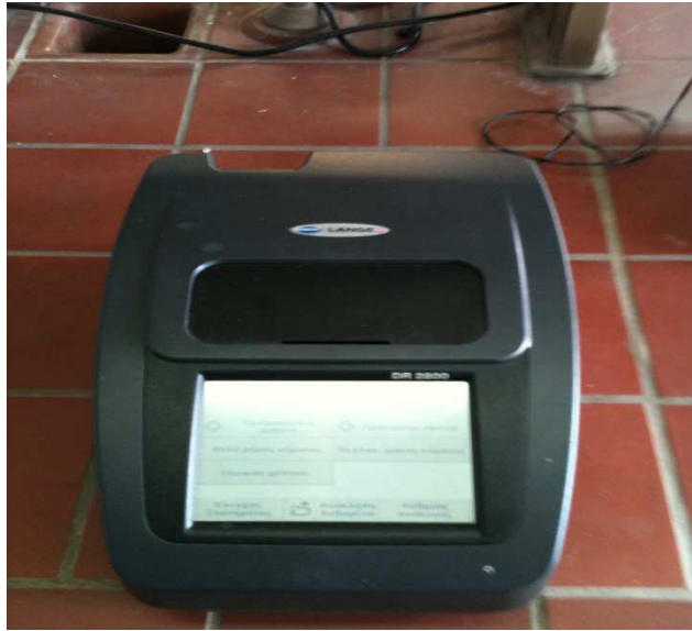
Σχήμα 22: Φασματοφωτόμετρο DR 2800 HACH
