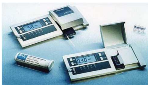
Σχήμα 6: Ανακλασίμετρο τύπου RQflex plus 10 της Merck.
