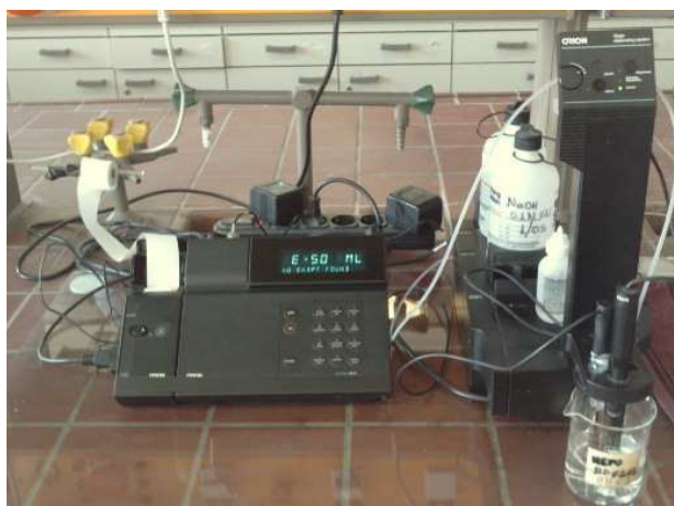
Σχήμα 9: Αυτόματος τιτλοδότης ORION
