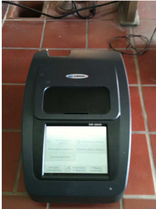
Σχήμα 8: Φασματοφotόμετρο DR 2800 HACK
