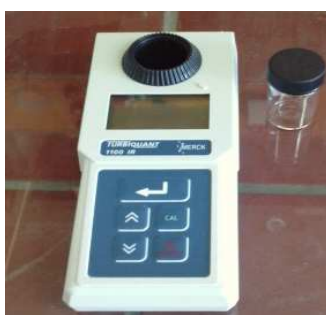
Σχήμα 5: Θολερόμετρο turbiquant 1100 R.
