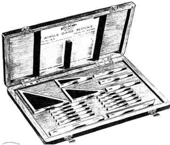
Σχέδιο 2-3. Σύνολο φραγμών διαμετρημάτων γωνίας που περιέχει 16 μεμονωμένους φραγμούς για τον καθορισμό οποιασδήποτε γωνίας, από μηδέν έως 90 βαθμούς, στις αυξήσεις \frac{1}{2} του τόξου
