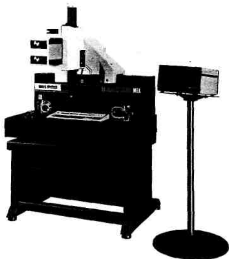
Σχ. 4-8. Μηχανή τοποθετημένη στο έδαφος, μηχανή μέτρησης συντεταγμένων.
