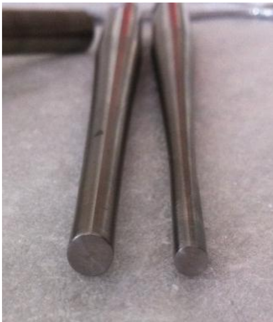
Εικόνα 11: φαίνεται αριστερά η επιφάνεια των ηχοδίων μετά από τη λείανση στο μηχανουργείο και πώς είναι, στη δεξιά εικόνα μετά από αρκετές ώρες χρήσης. Όσο πιο μικρή είναι η επιφάνεια της «μύτης» τόσο πιο μεγάλη είναι η φθορά που προκαλείται λόγω της σπηλαιώσης.
