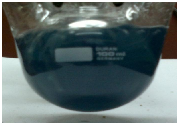
Εικόνα 14: το YB-3, το μπλε χρώμα οφείλεται στη μετατροπή του προδρόμου MoE σε οξύδιο του Μολυβδενίου στο αριστερό και δεξιό στόμιο παρατηρούνται κρύσταλλοι που έχουν δημιουργηθεί από την εξάτμηση και επανυγροποίηση της δεκαλίνης στα τοιχώματα.
