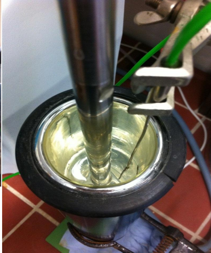
Εικόνα 10: η διάταξη της βαθμονόμησης, όπου φαίνεται η «μύτη» του ηχοδίου, το νερό και το θερμοστοιχείο.
