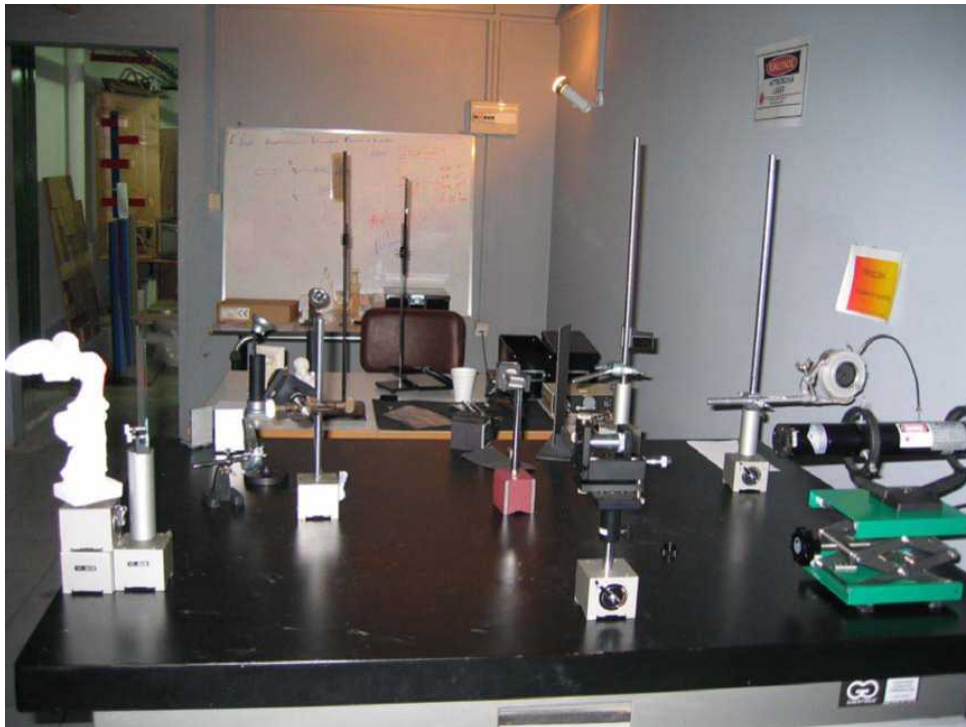
Εικόνα 15: Εργαστηριακή διάταξη Παραγωγής Ολογράμματος (Πηγή Σημ. Ολογραφίας Αρχιτεκτ. ΕΜΠ, 2004)
