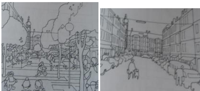
Εικόνα 5.25-5.26- Διαμόρφωση ενός τυπικού δρόμου σε δρόμο ήπιας κυκλοφορίας.Πριν και μετά την διαμόρφωση (Μελέτη πηγή: Μ.Εichenauer et al, 1979,p.24
