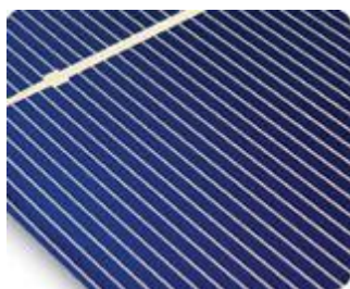
Εικόνα 2.5.1 : Κυψέλη μονοκρυσταλλικού πυριτίου
