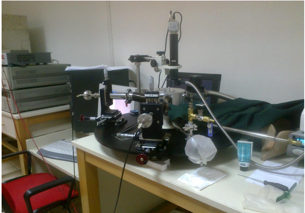
Εικόνα 5.4.6 : Διάταξη για ηλεκτρικές μετρήσεις σε χαμηλές θερμοκρασίες και συνθήκες κενού
