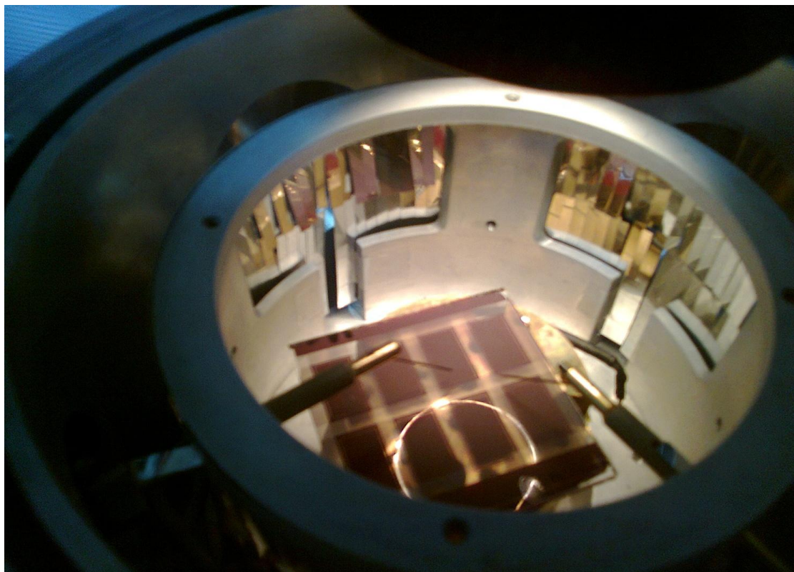
Εικόνα 5.4.7 : Θάλαμος χαμηλών θερμοκρασιών
